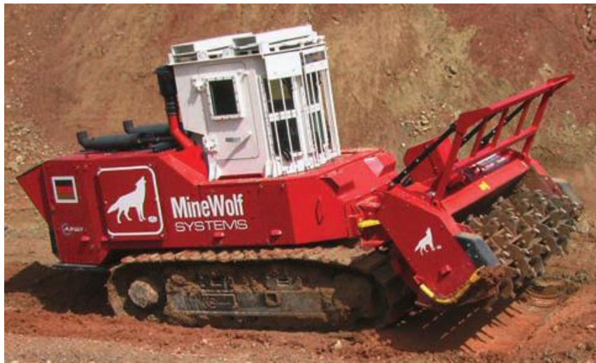
Slika 2. Stroj sa sitnilicom [4]
