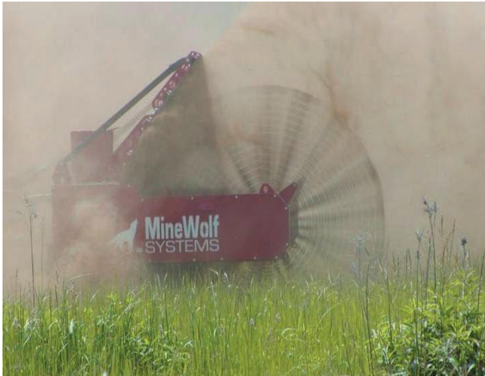
Slika 10. Stroj za razminiranje u procesu rada, radni alat- mlatilo [4]
