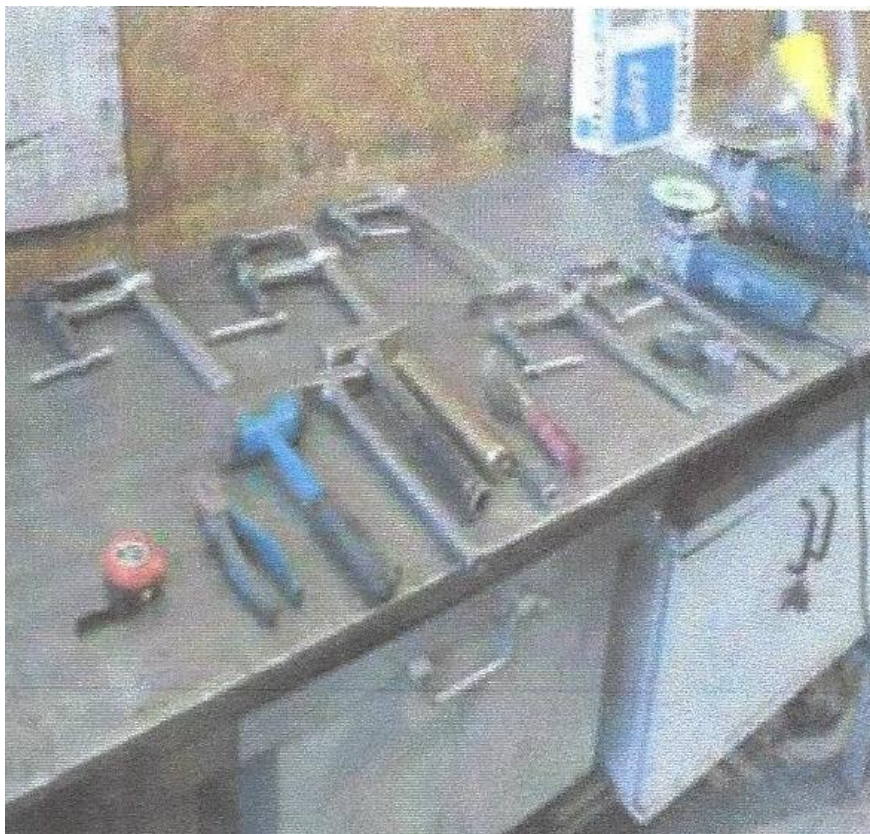
Slika 23. Stege, brusilice s pločama, čekić [11]
