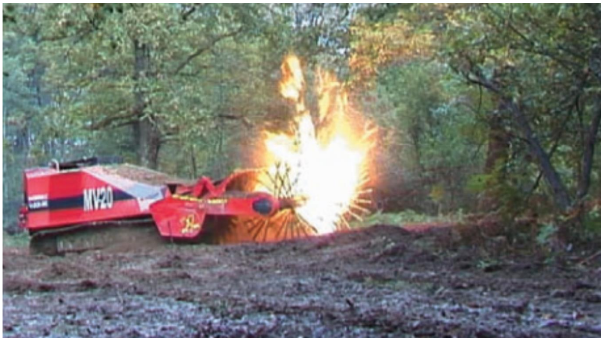
Slika 11. Detonacija mine ispod mlatila [4]
