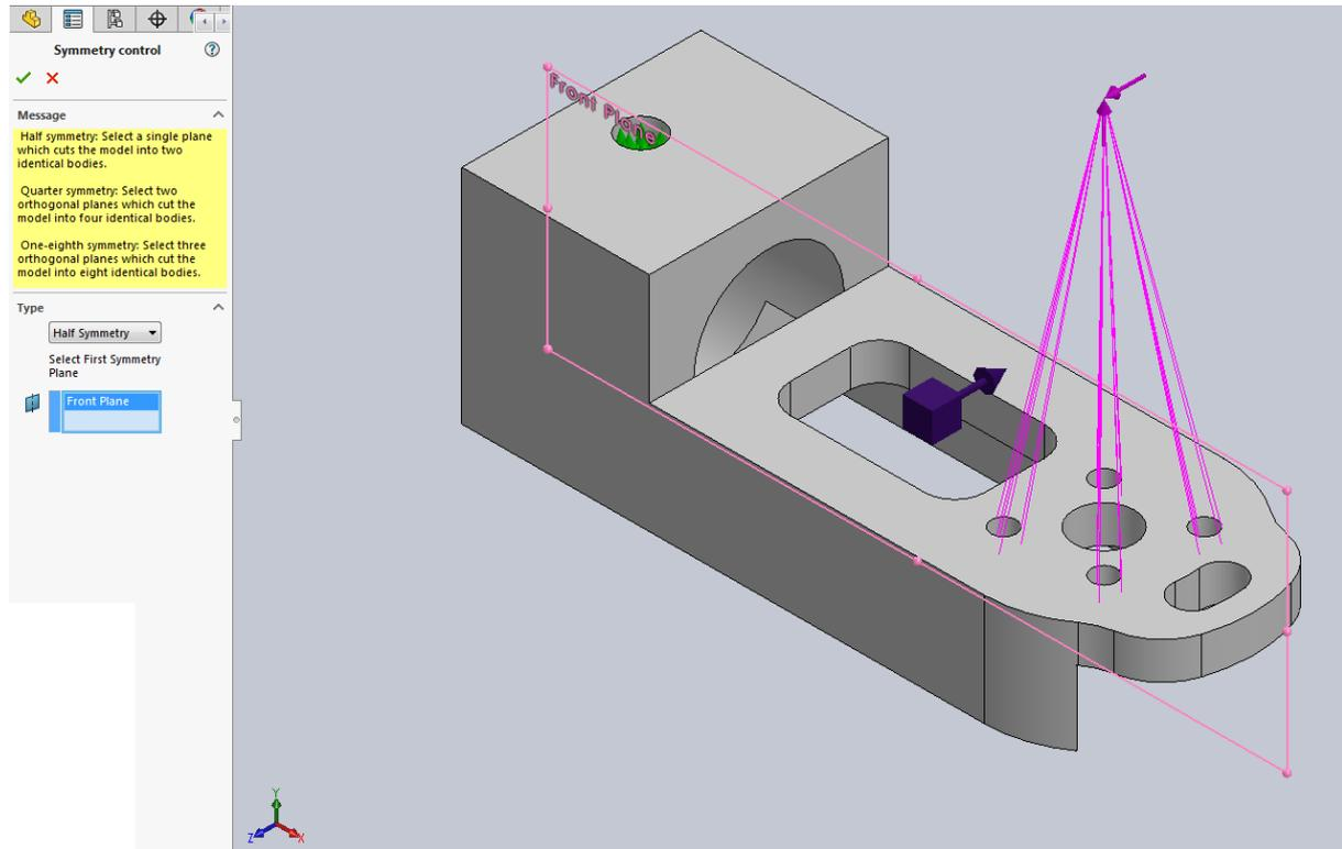
Slika 53. Simetrija optimizacije na modelu nosača elektromotora.
