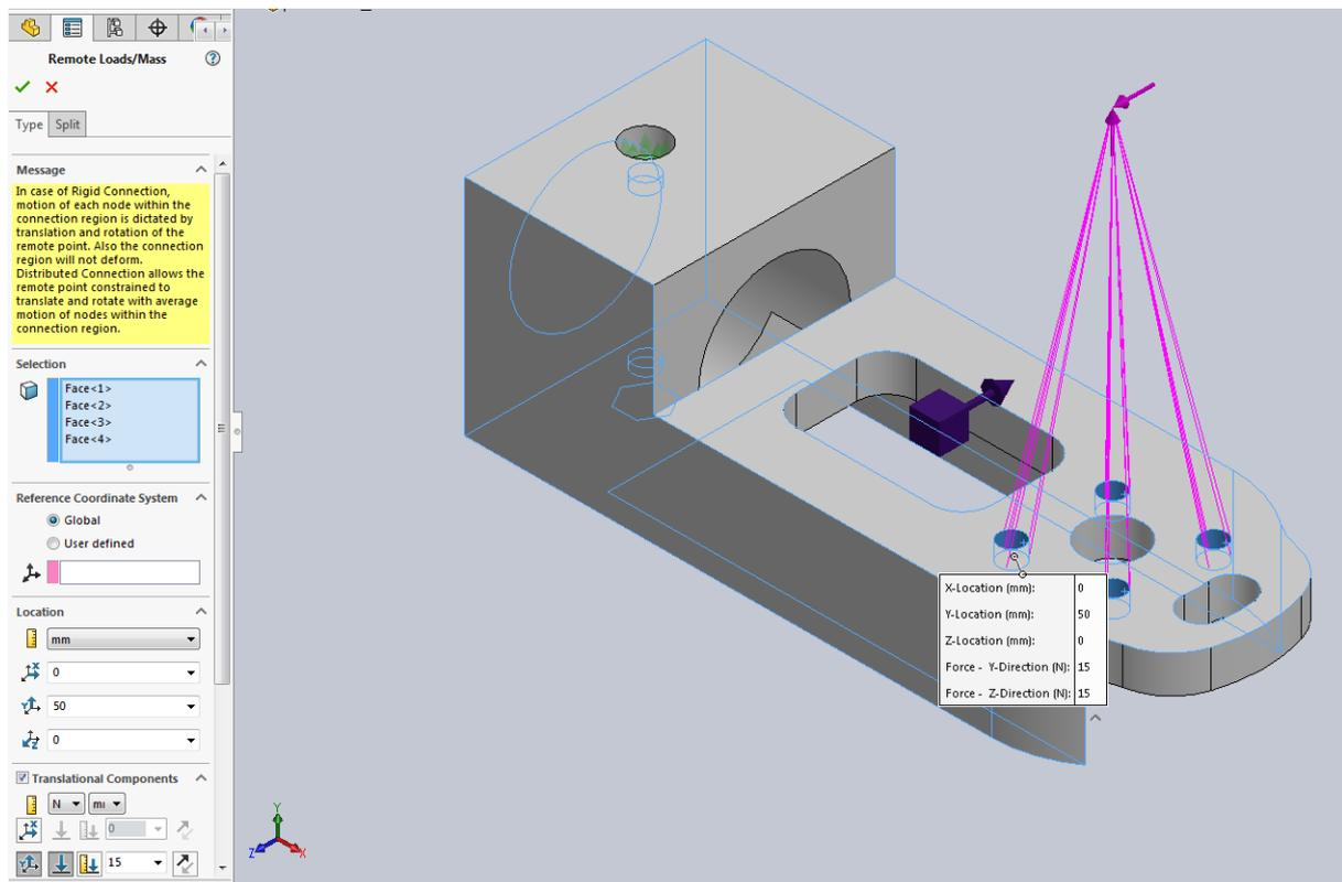
Slika 49. Djelovanje sile na nosač elektromotora.
