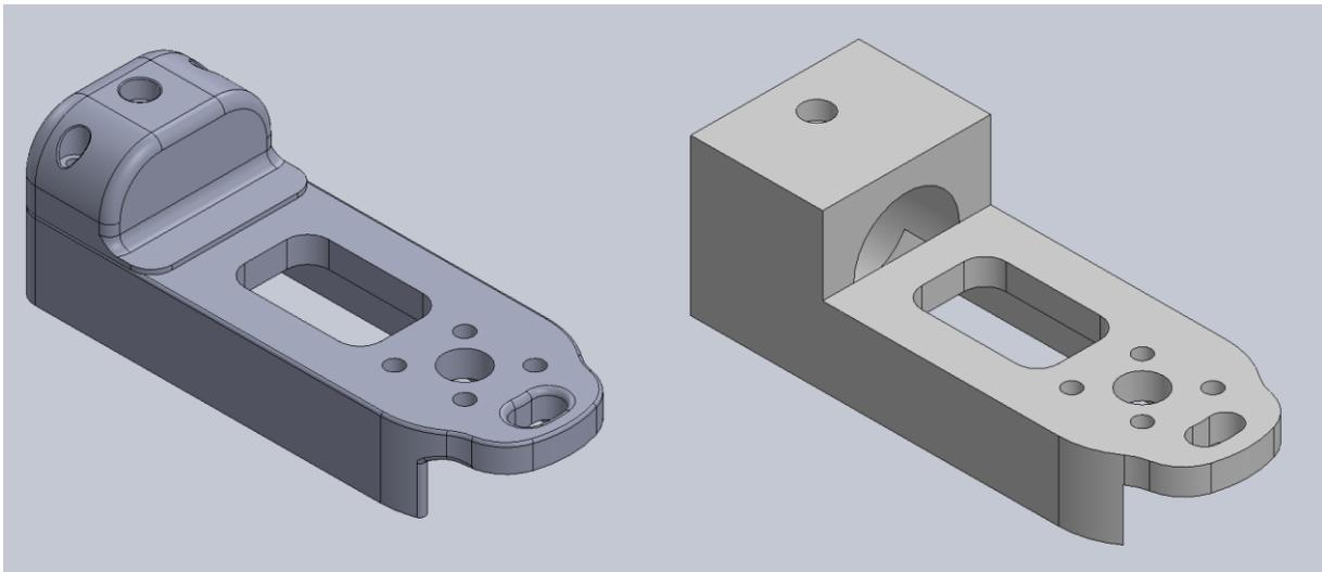
Slika 45. Novi model nosača elektromotora za optimizaciju.
