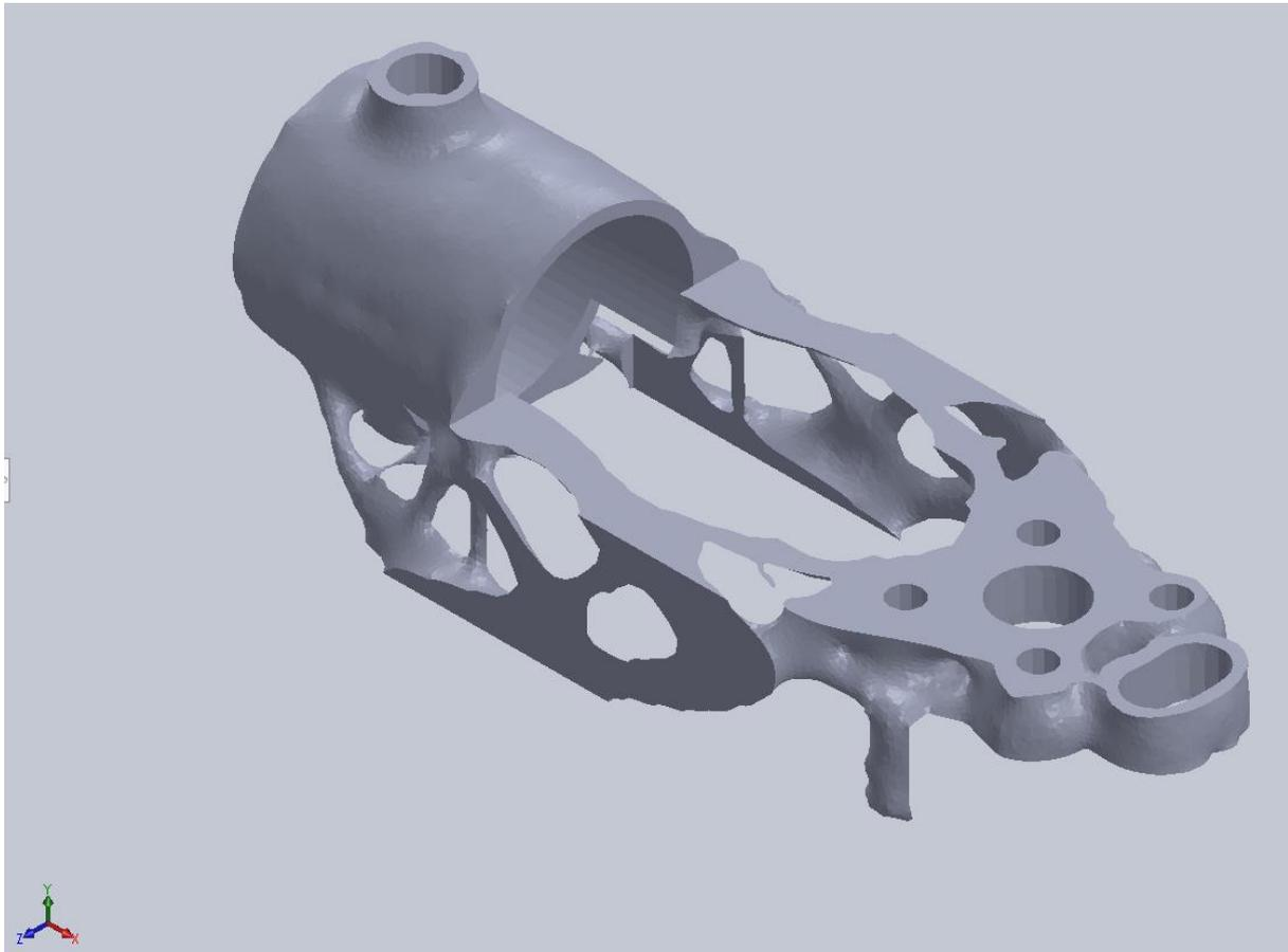
Slika 56. Topološki optimiziran model nosača elektromotora.
