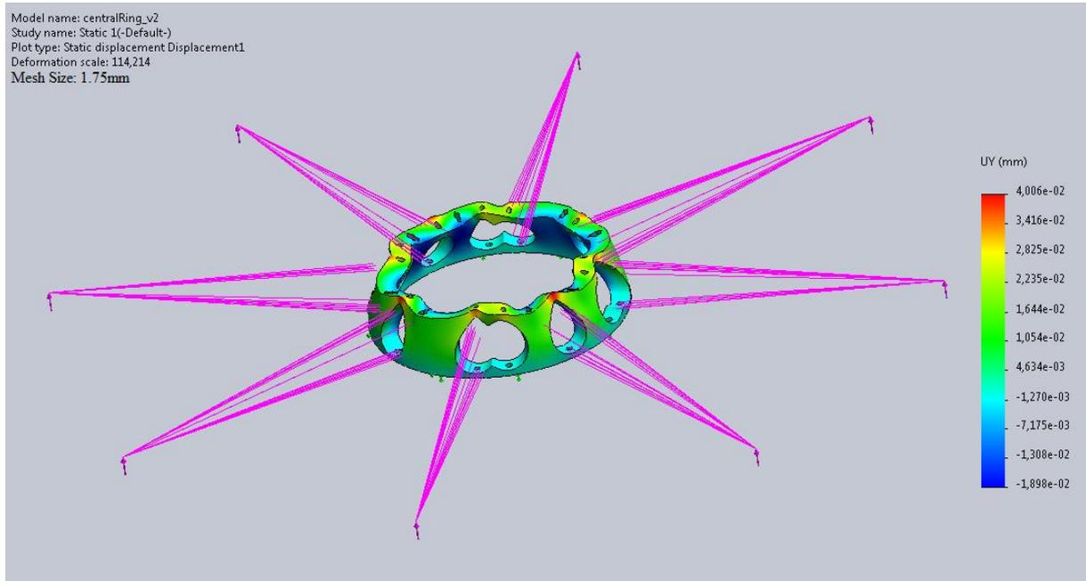
Slika 27. Simulacija pomaka kućišta drona.
