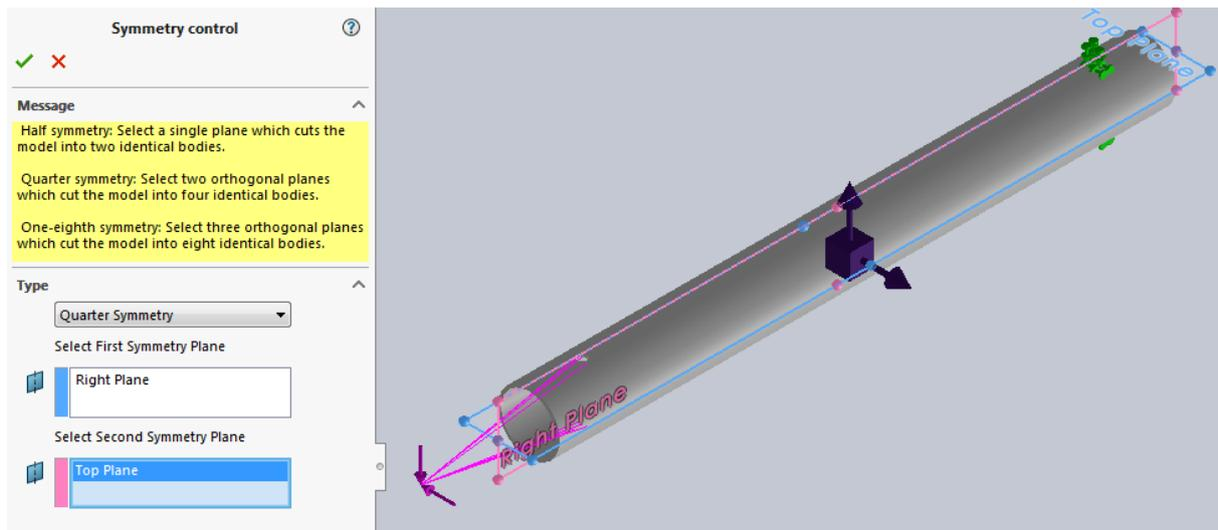
Slika 16. Simetrija optimizacije na modelu kraka elektromotora.
