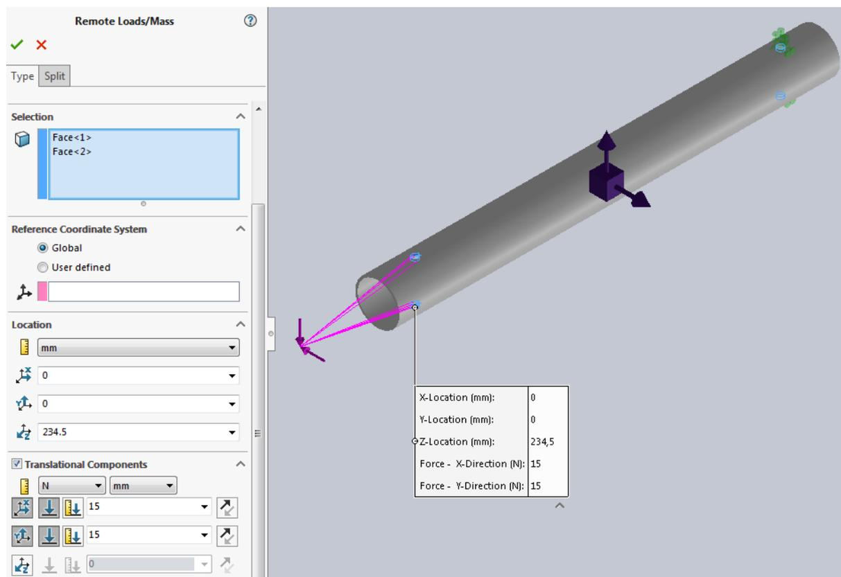
Slika 12. Djelovanje sile uzgona elektromotora na krak drona.
