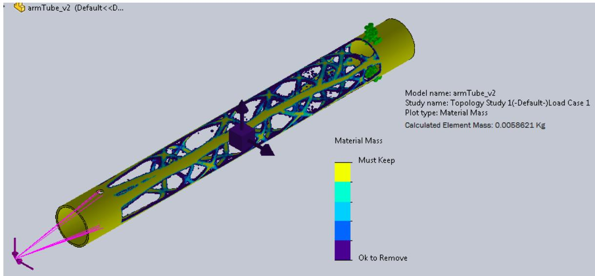
Slika 19. Gotova simulacija optimizacije kraka elektromotora drona.
