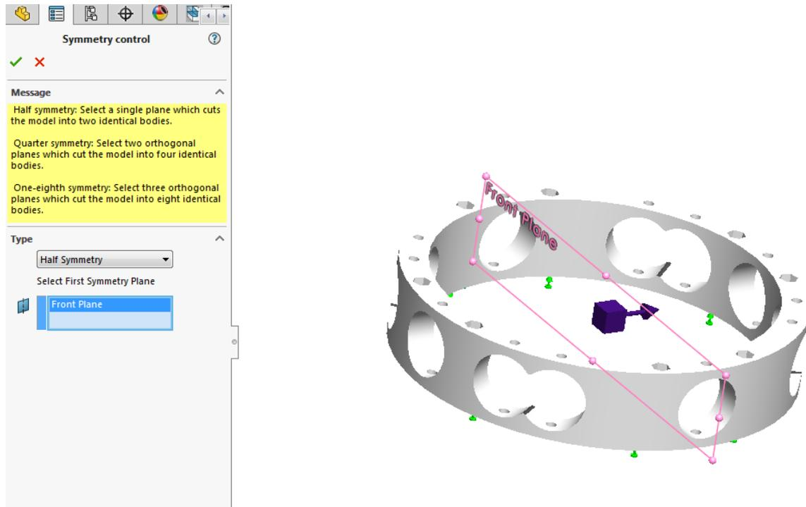
Slika 37. Simetrija optimizacije na modelu kućišta drona.
