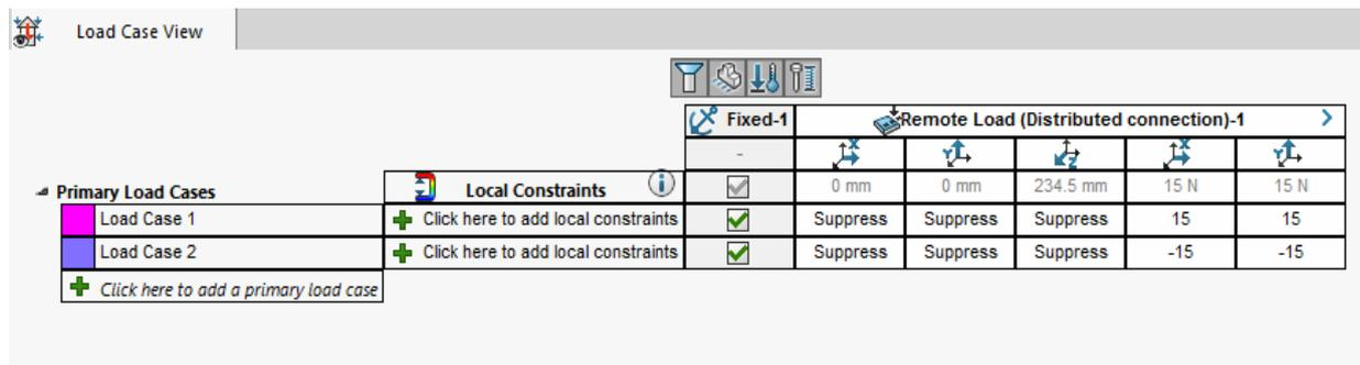
Slika 13. Upravitelj djelovanja sila na krak elektromotora drona.
