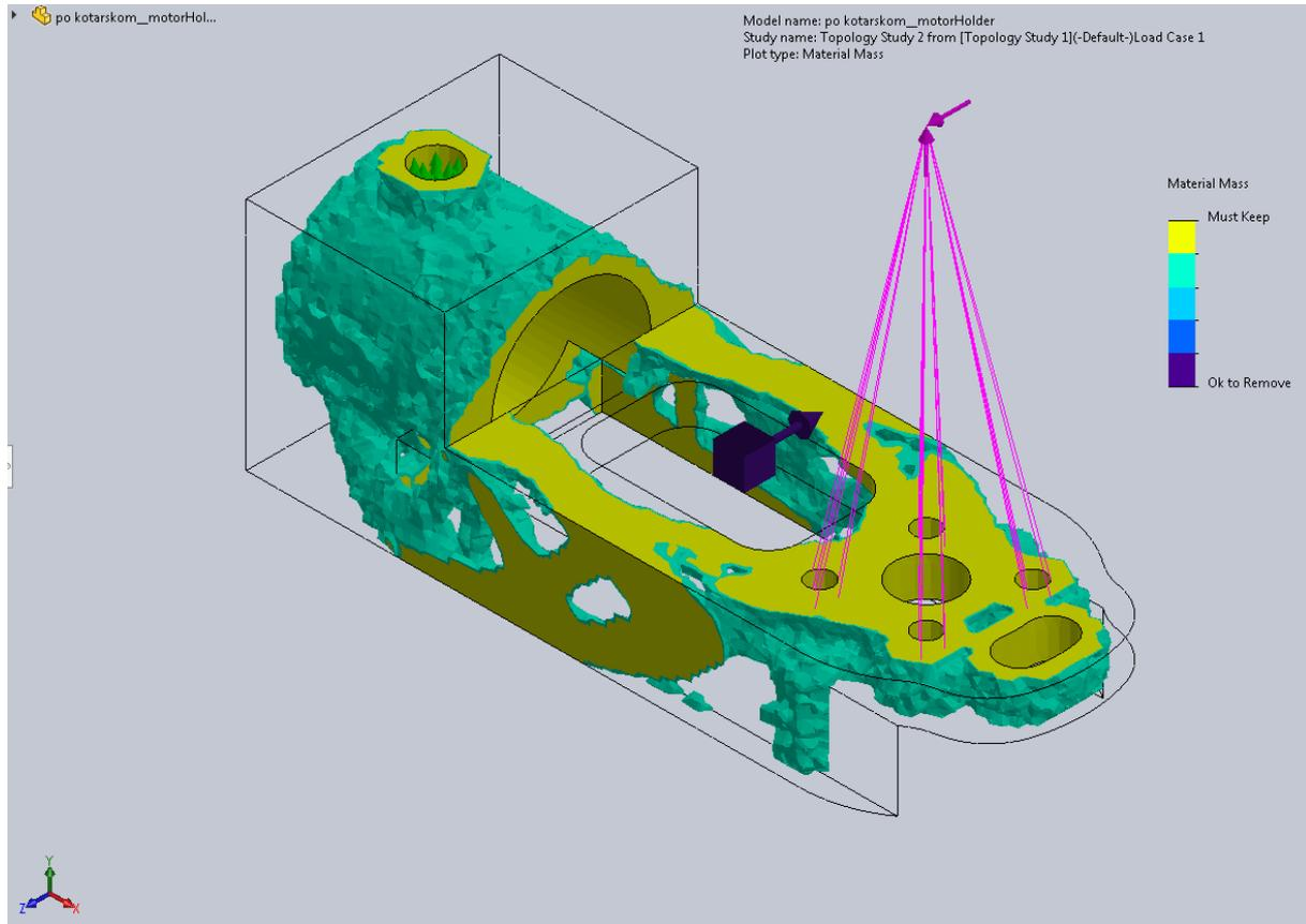
Slika 55. Gotova simulacija nosača elektromotora.
