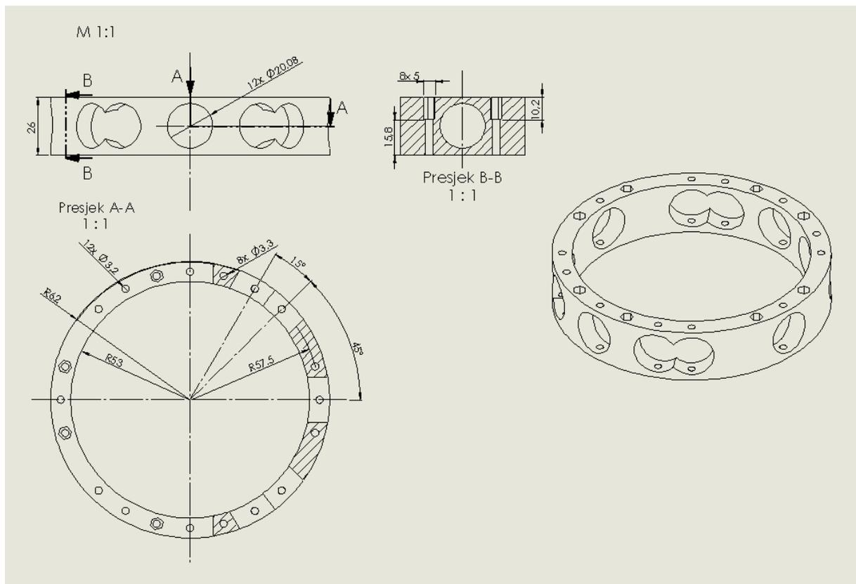
Slika 26. Nacrt kućišta drona.
