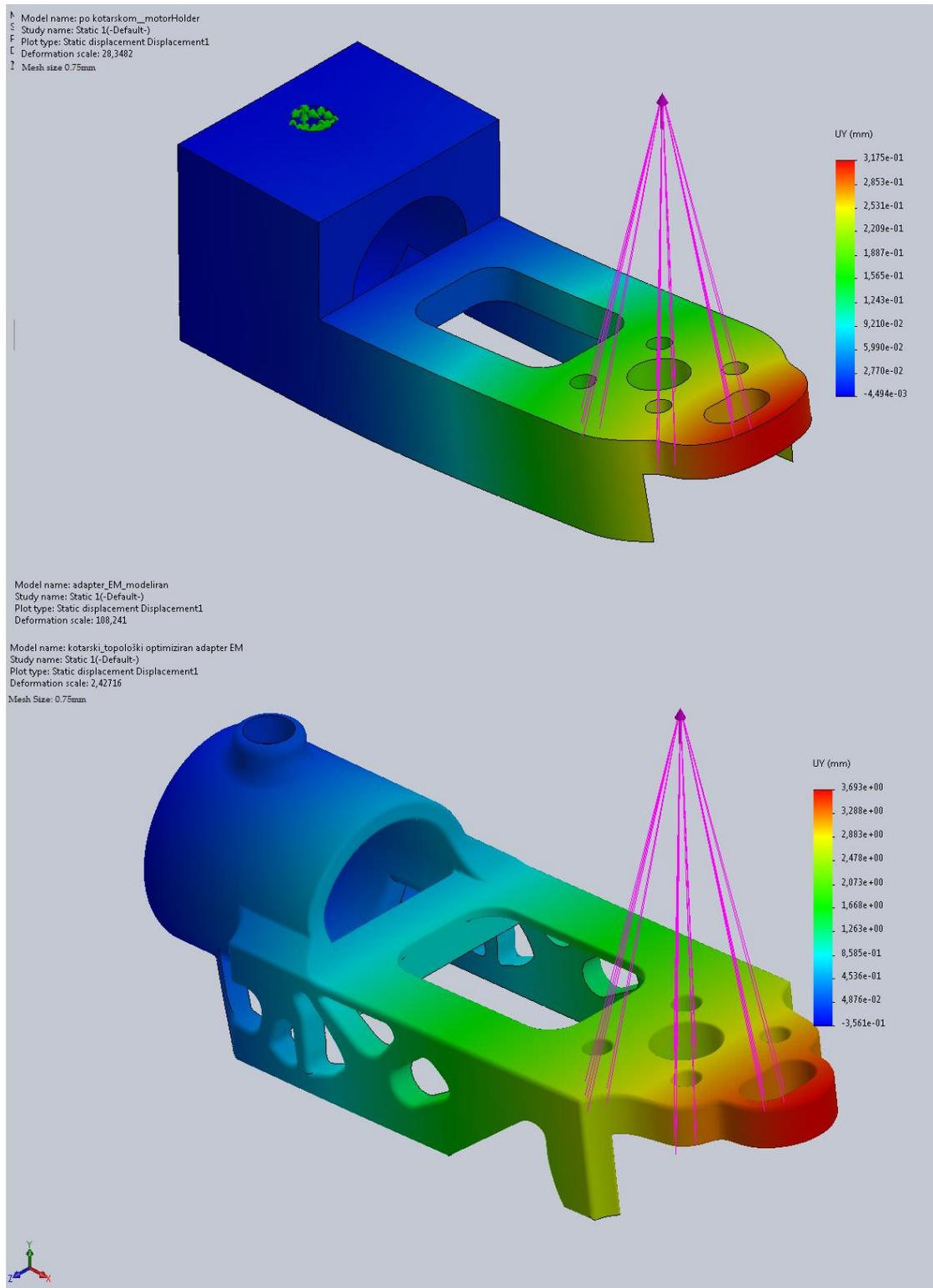
Slika 58. Statički pomak nosača elektromotora prije i poslije optimiziranja.
