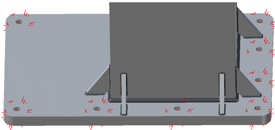
Slika 29. Uklještenje konstrukcije dvostupne dizalice
