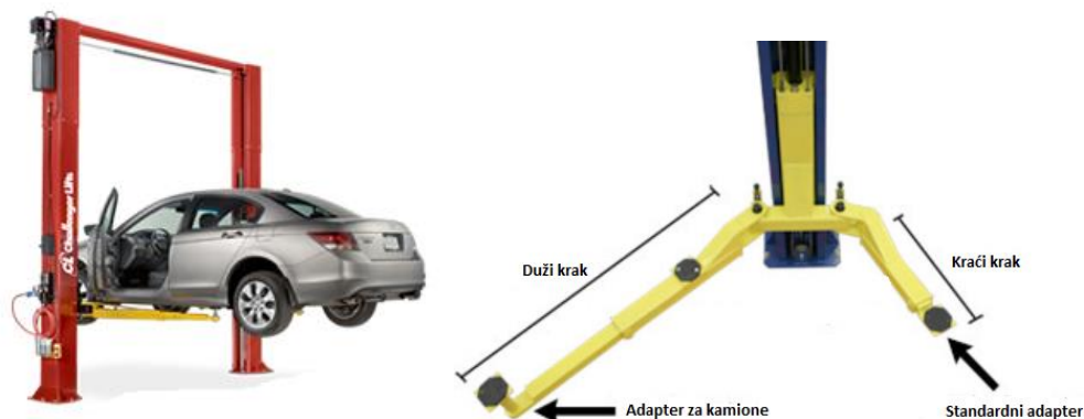
Slika 2. Dvostupna asimetrična dizalica [7,8]
