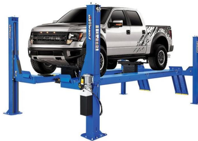
Slika 8. Dizalica za poravnanje kotača [14]
