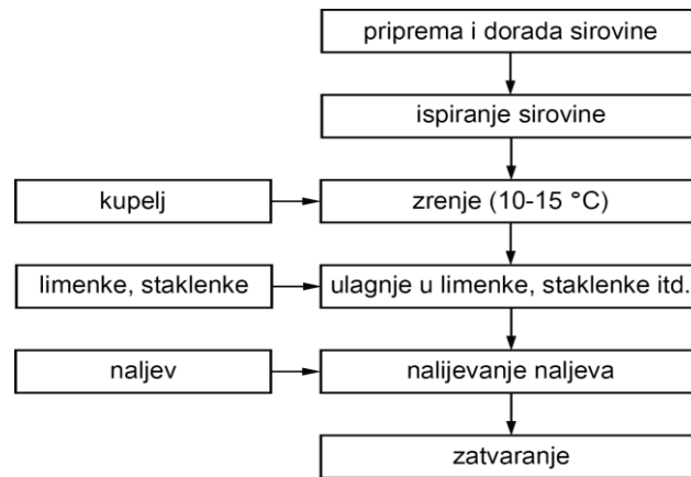
Slika 9 Proces proizvodnje hladnih marinada prema Soša (1989).
