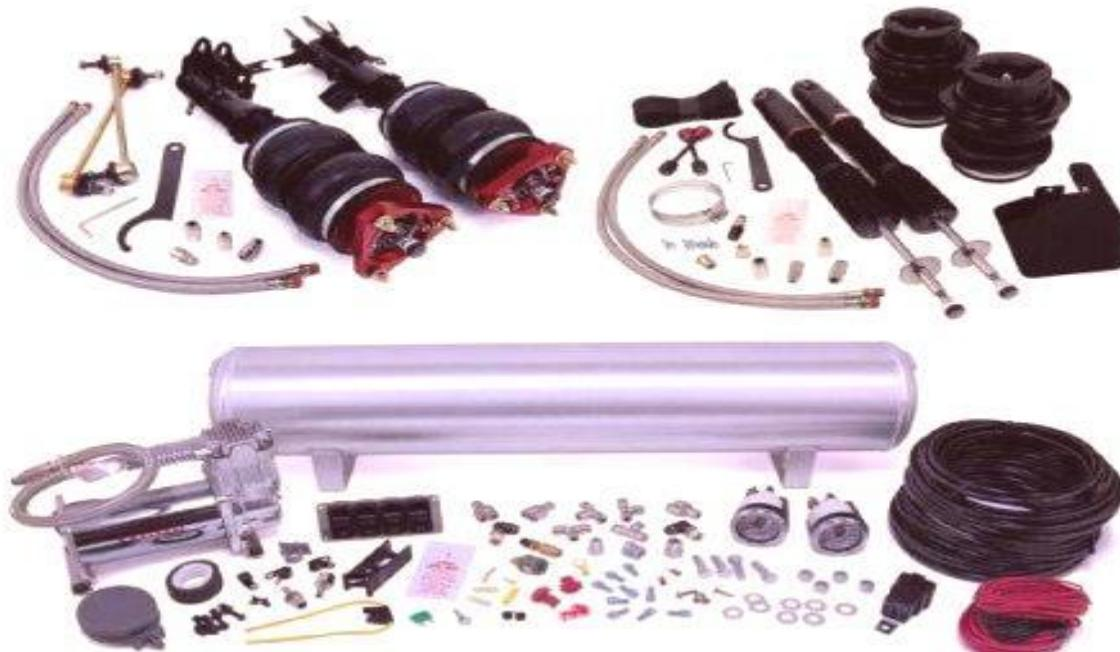
Slika 3: Dijelovi pneumatskog ovjesa
