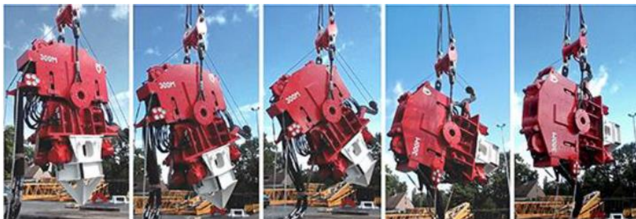
Slika 24. Mogućnosti rotacije sustava Upending Technology [23]
