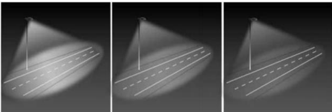
Slika 10. LED rasvjeta prilikom kvara pojedinih modula (kada svaki modul osvjetljava cijelu površinu pokrivenosti svjetiljke).[28]
