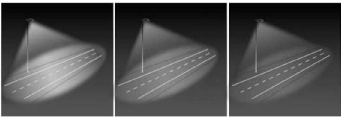
Slika 10. LED rasvjeta prilikom kvara pojedinih modula (kada svaki modul osvjetljava cijelu površinu pokrivenosti svjetiljke).[28]
