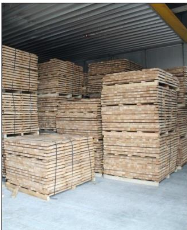
Slika 19. Pravilno složena drvena građa [19]
