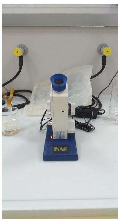
**Slika 6.** Abbeov refraktometar
