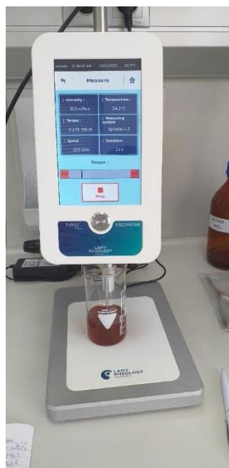
**Slika 8.** Rotacijski viskozimetar
