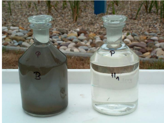
Slika 14. Prikaz ulaznog i izlaznog primjerka vode
