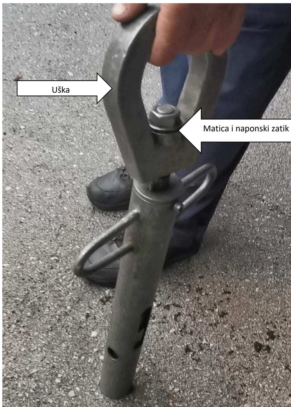
Slika 17. Naprava za podizanje bubnjeva u početnom položaju
