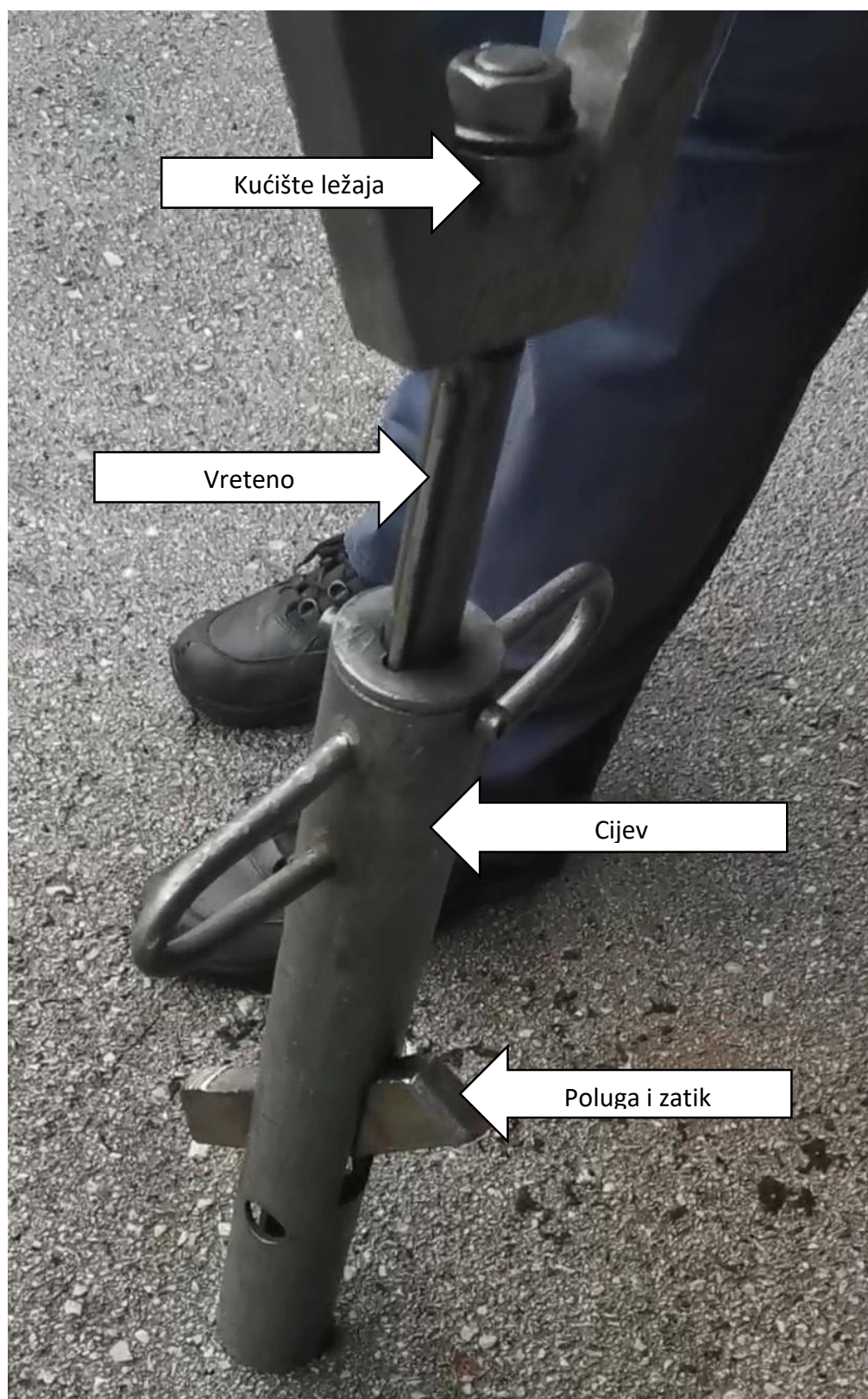
Slika 18. Izvlačenje vretena i izlazak poluge iz cijevi
