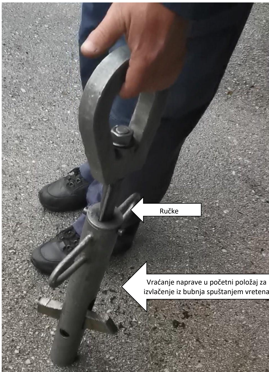
Slika 20. Vraćanje vretena i poluge u cijev za izvlačenje naprave iz bubnja
