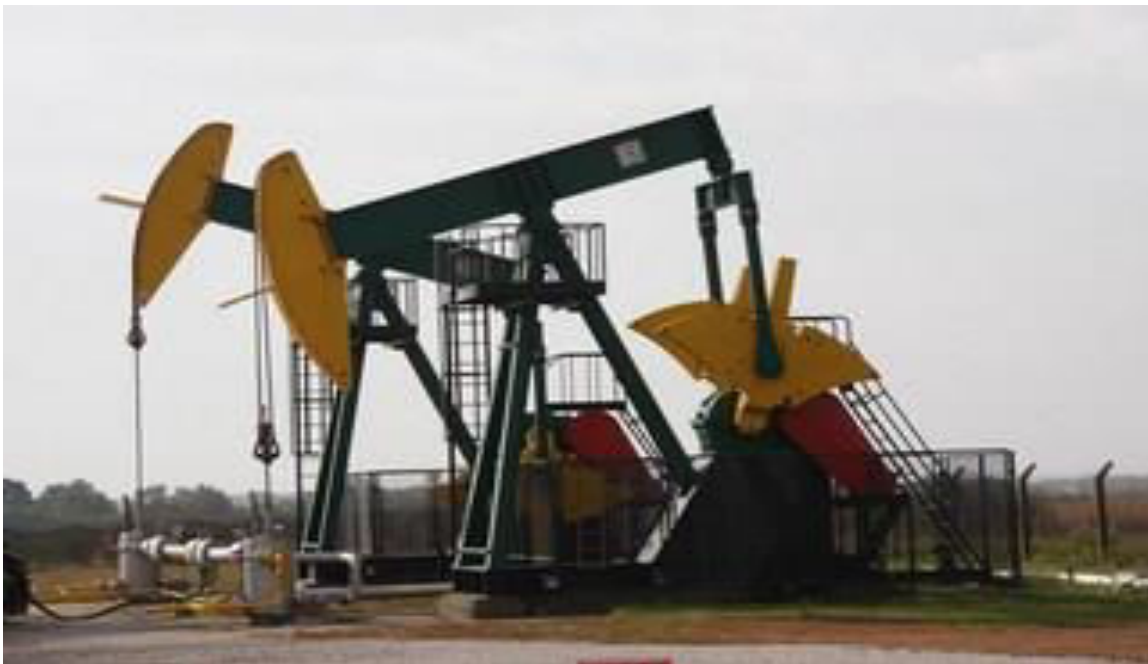
Slika 1 Podizanje nafte dubinskim sisaljka [7]
