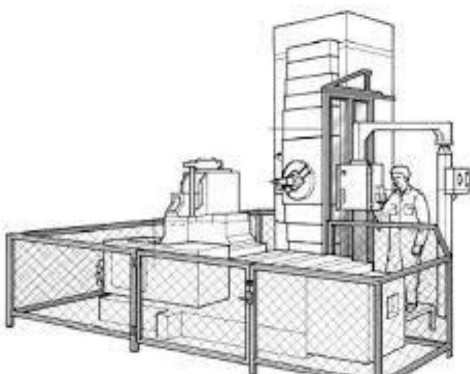
Slika 6. Zaštitna ograda na tokarskom stroju [5]
