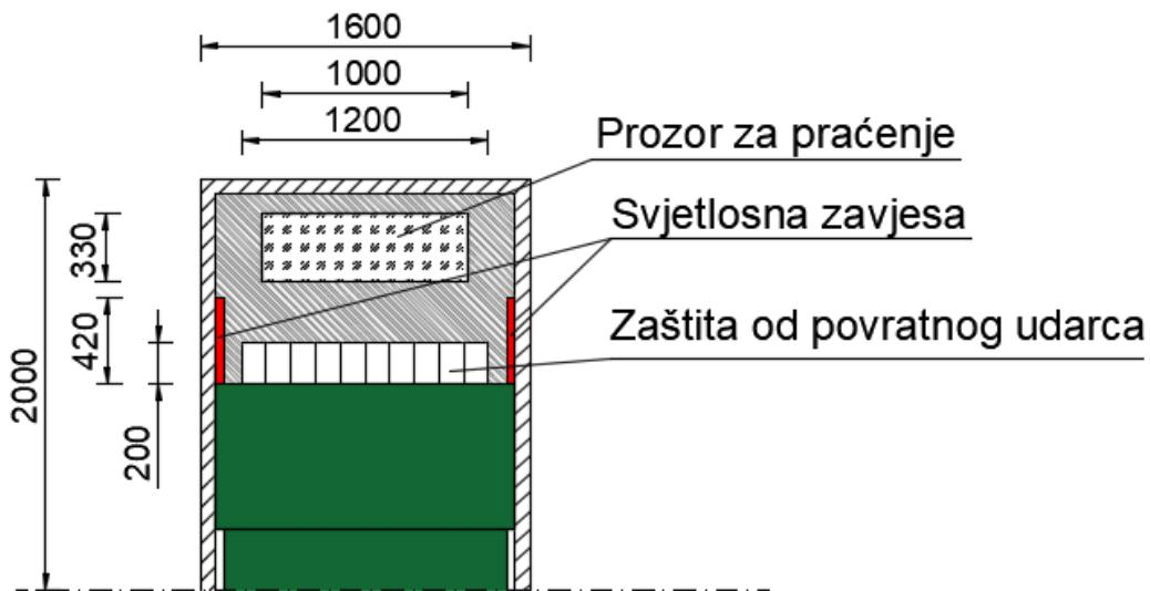
Slika 37. Shematski prikaz položaja svjetlosne zavjesa i zaštite od povratnog udarca, desna strana stroja (izradio autor)
