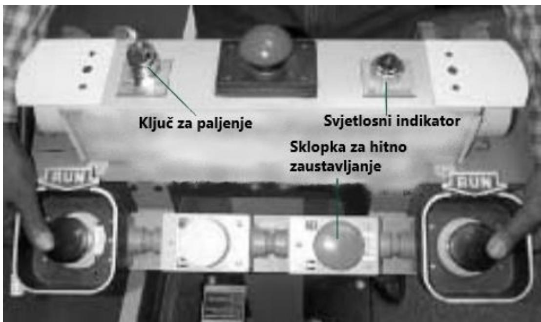
Slika 10. Primjer dvoručnog sustava za pokretanje hidrauličke preše [5]
