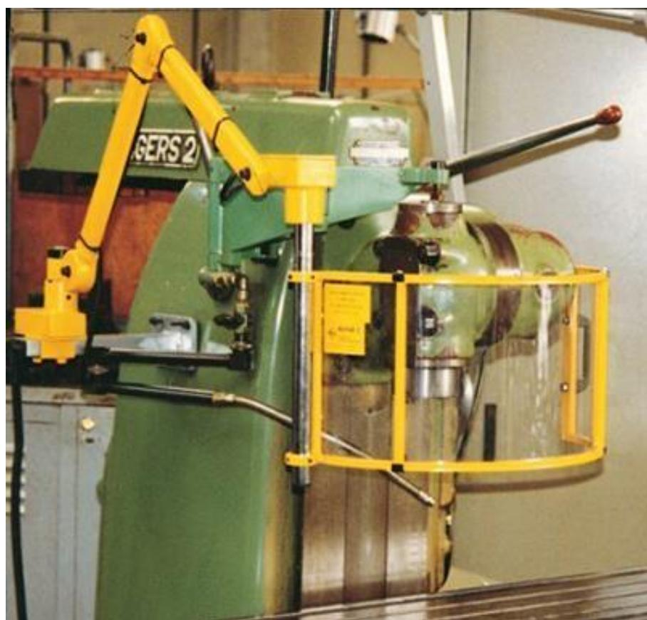
Slika 8. Primjer pomične zaštitne naprave na glodalici pokretljive u svim smjerovima
