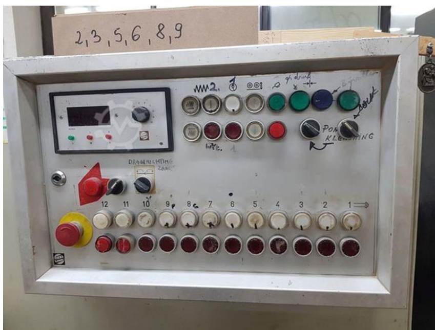
Slika 28. Komandna ploča za pomicanje vretena i kontrolu dimenzija obradka (Stolarija Jakopčin)
