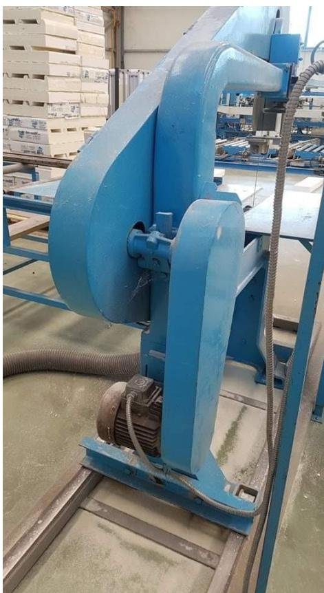
Slika 5. Zaštita na remenici elektromotora (Stolarija Jakopčin)
