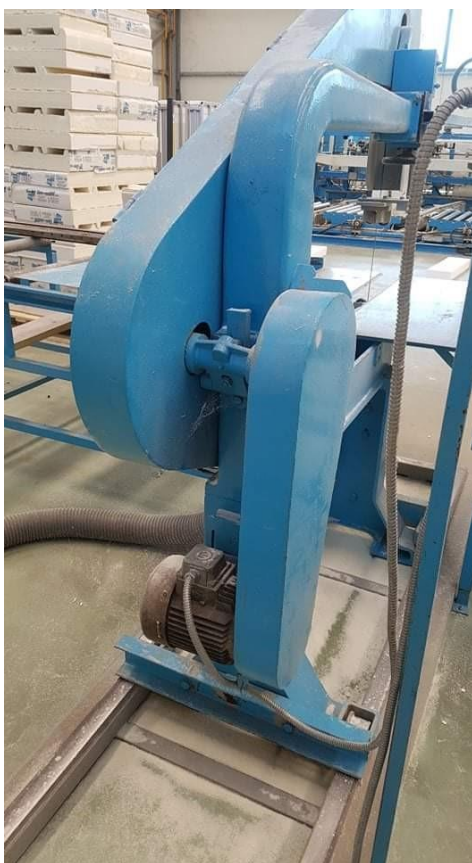
Slika 5. Zaštita na remenici elektromotora (Stolarija Jakopčin)
