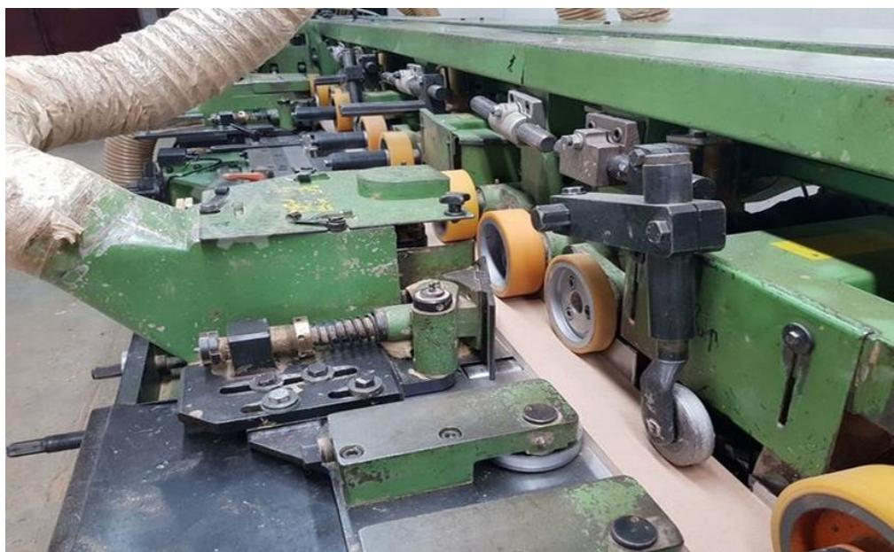
Slika 26. Primjer pomičnih hidrauličkih vretena (Stolarija Jakopčin)
