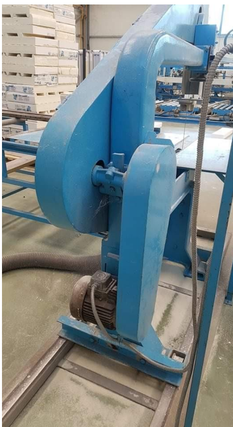
Slika 5. Zaštita na remenici elektromotora (Stolarija Jakopčin)
