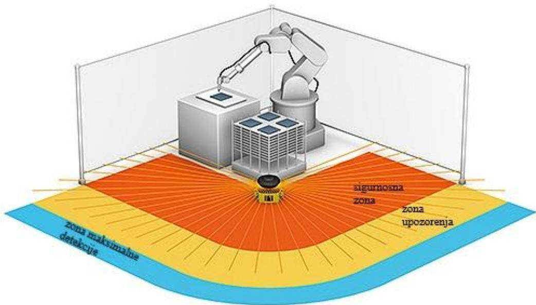
Slika 21. Primjer rada sigurnosnog laserskog skenera [8]
