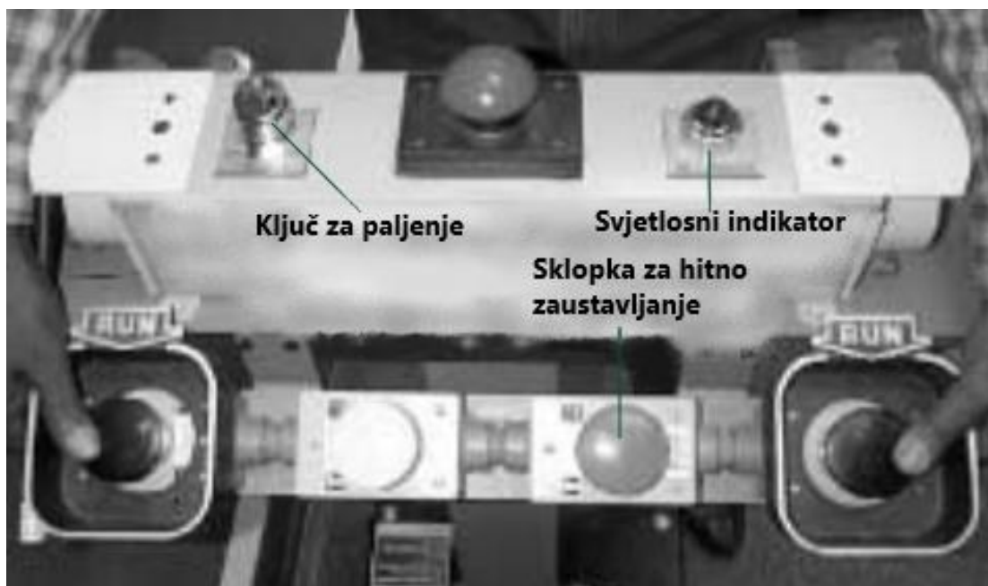
Slika 10. Primjer dvoručnog sustava za pokretanje hidrauličke preše [5]
