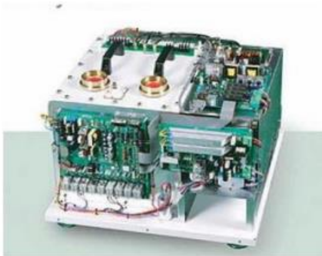
Slika 15. Generator rendgenskog uređaja
