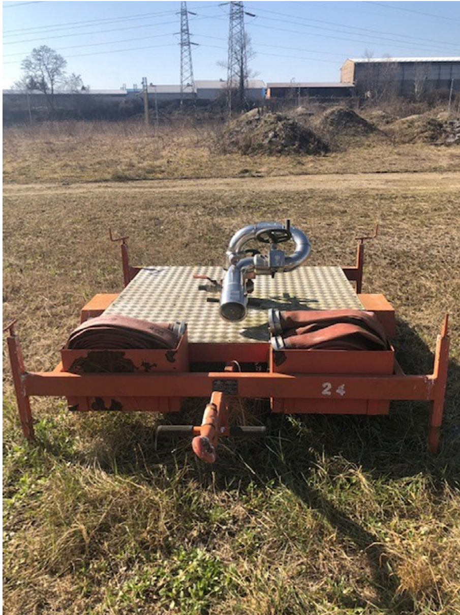
Slika 15. Mobilni bacač voda/pjena na KP-7 [7]
