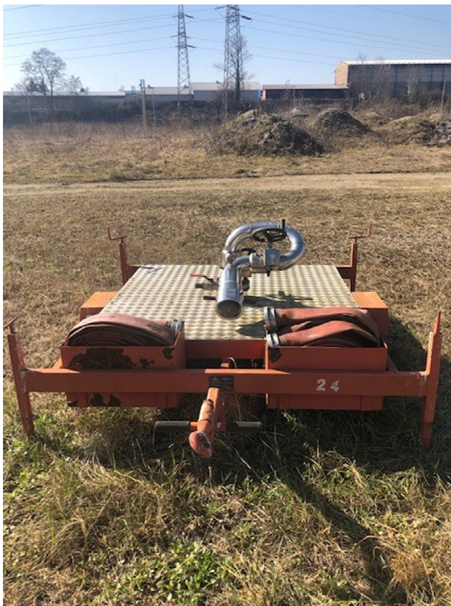
Slika 15. Mobilni bacač voda/pjena na KP-7 [7]
