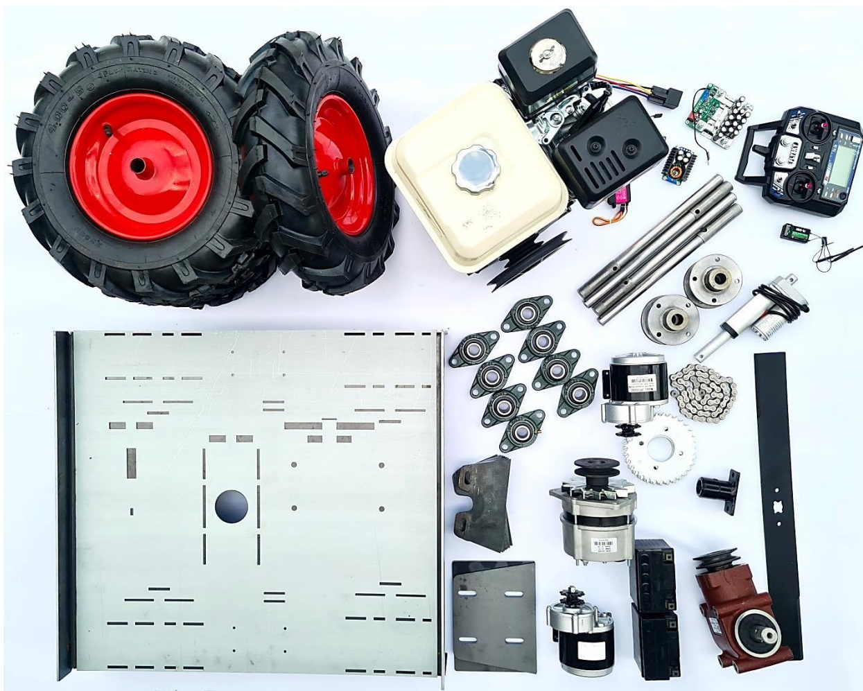
Slika 2 – Prikaz korištenih komponentata za izradu prototipa kosilice.
