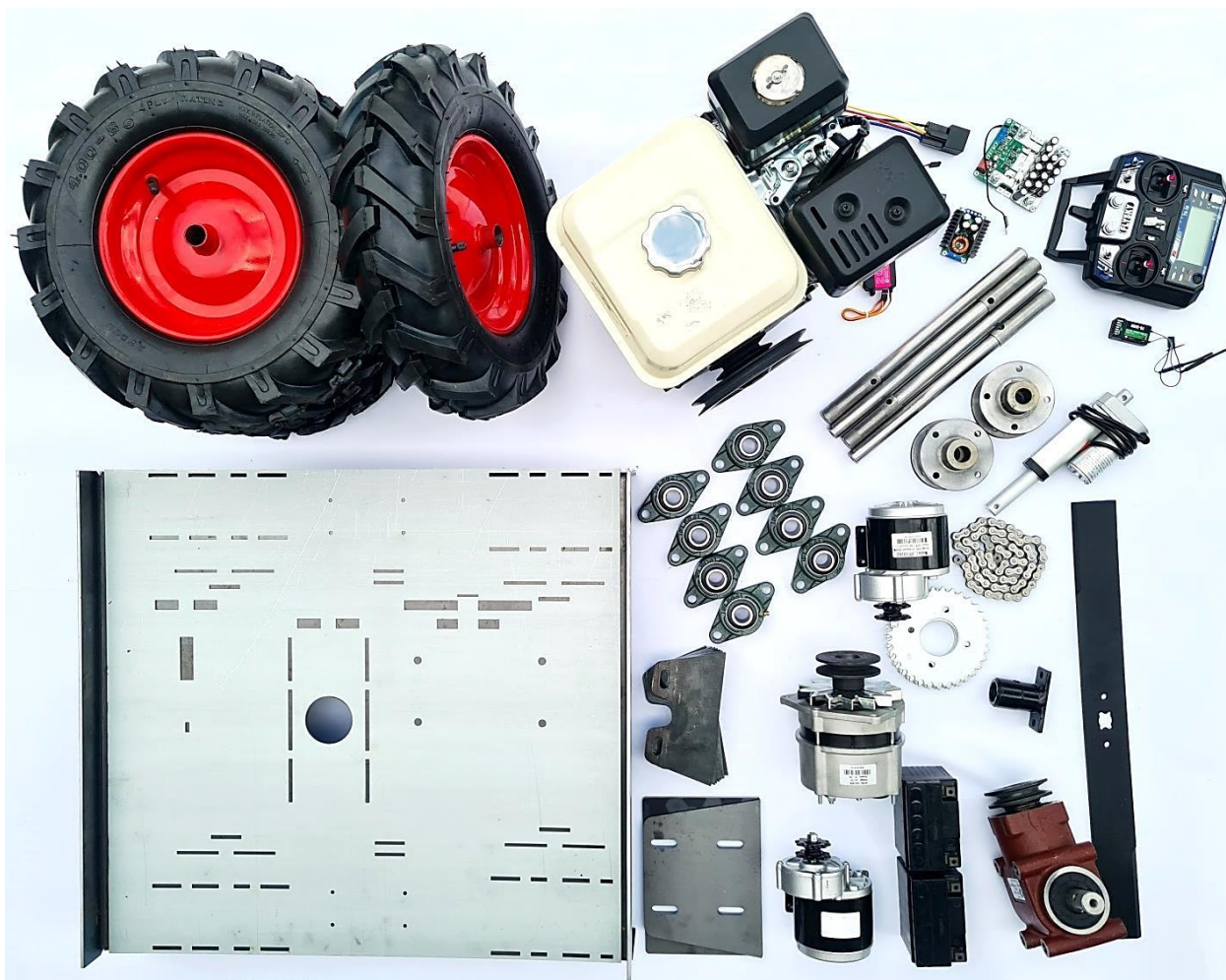
Slika 2 – Prikaz korištenih komponenata za izradu prototipa kosilice.
