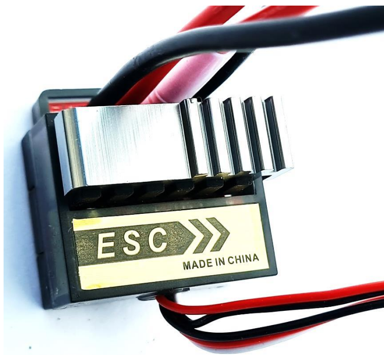
Slika 37 – ESC upravljačka jedinica.
