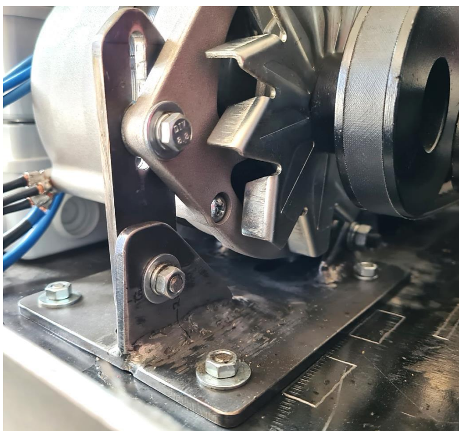
Slika 72 - Postolje alternatora sa polugom za pomicanje i alternatorom.
