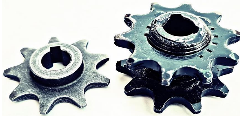
Slika 41 – Lančanik 410H, na lijevoj strani, skinut sa osovine elektromotora, a na desnoj strani je posebno izrađen dupli lančanik 415H.
