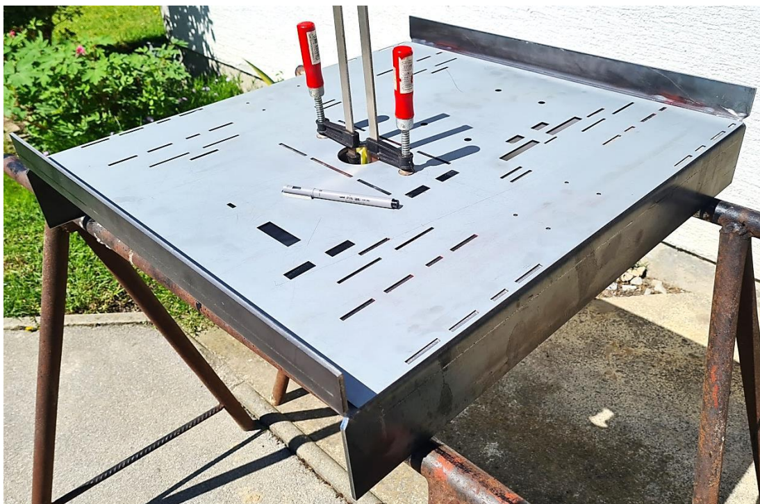
Slika 96 - Preslikavanje šablone na izrađeno glavno kućište kosilice.
