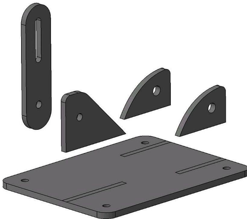
Slika 70 – 3D eksplodiran prikaz elemenata postolja alternatora.
