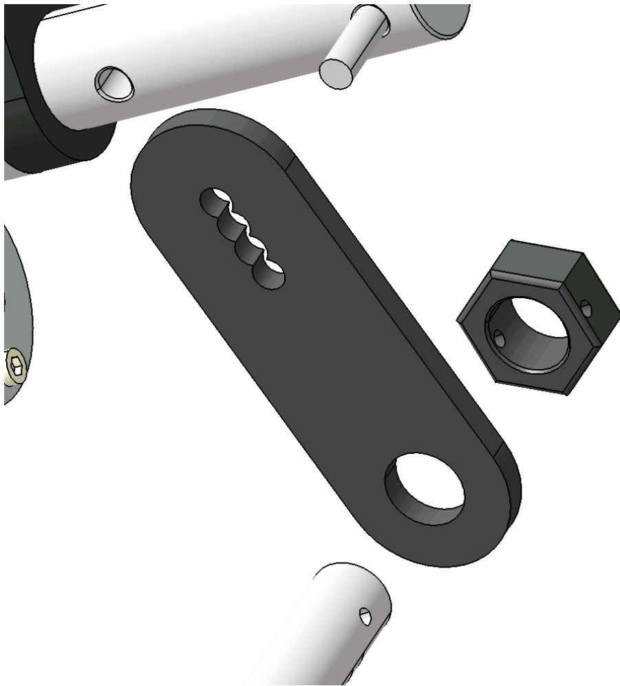
Slika 56 – 3D eksplodiran prikaz poluge linearnog akuatora i matice M14.
