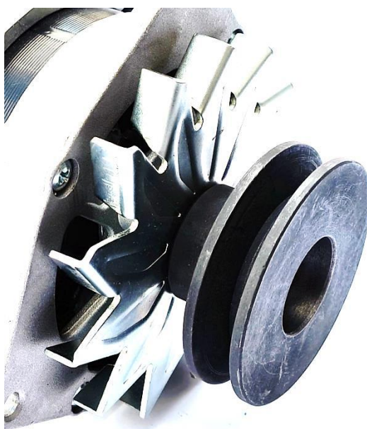
Slika 61 – Prikaz remenice učvršćene na alternator.
