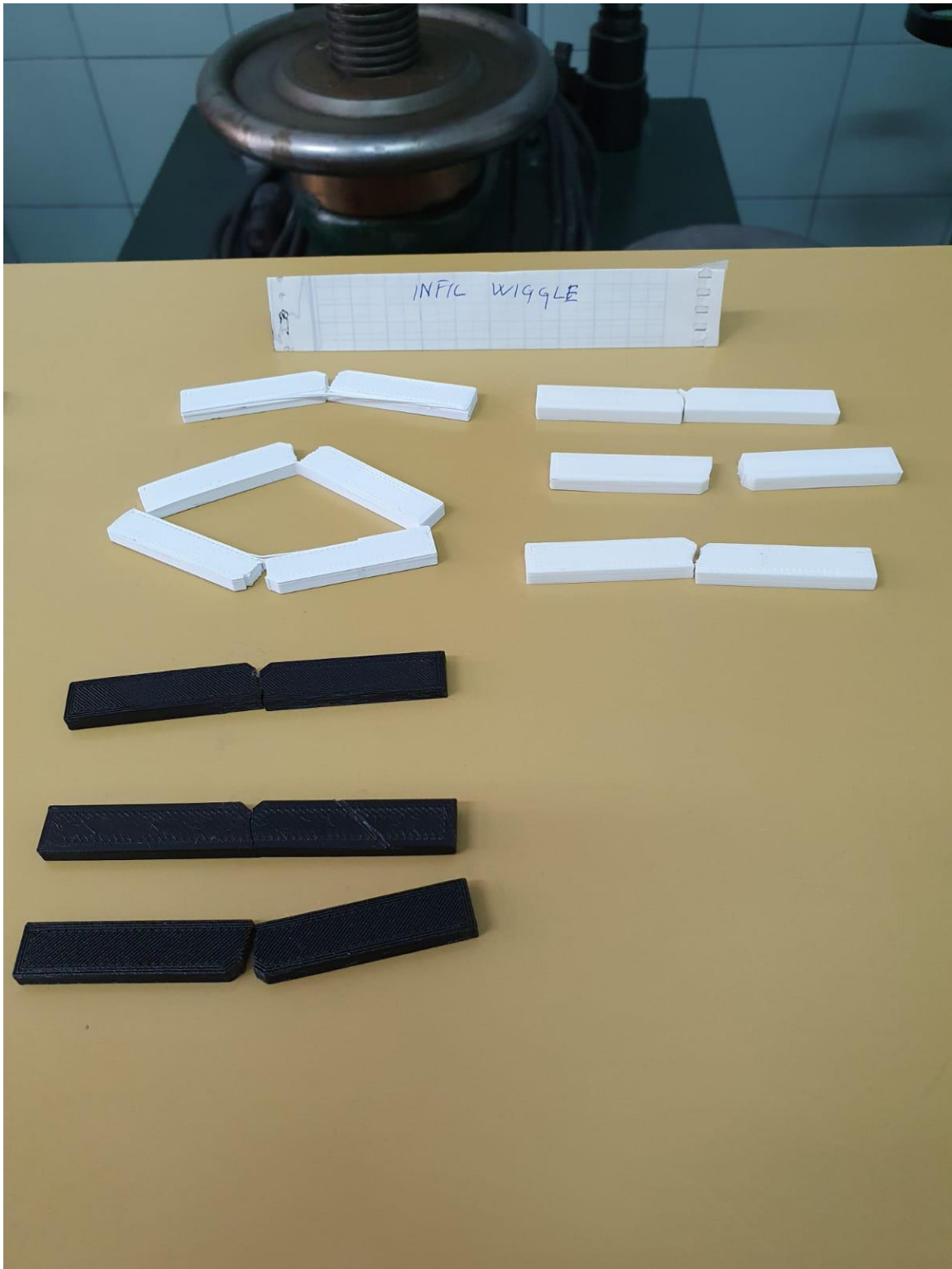
Slika 34. Prikaz ispitanih epruveta sa geometrijom ispune ( wiggle )
