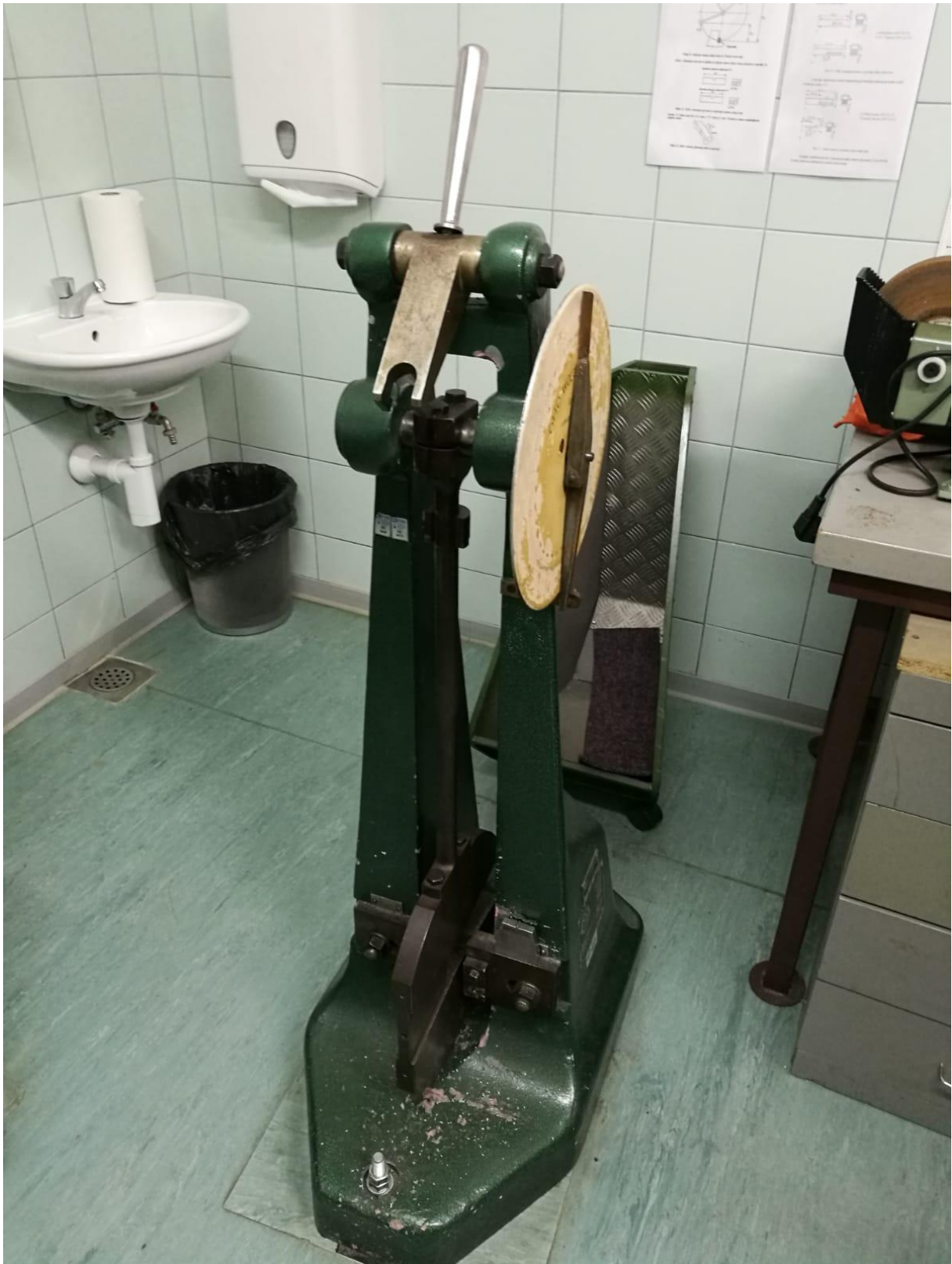
Slika 27. Otto wolpert werke uređaj za ispitivanje žilavosti
