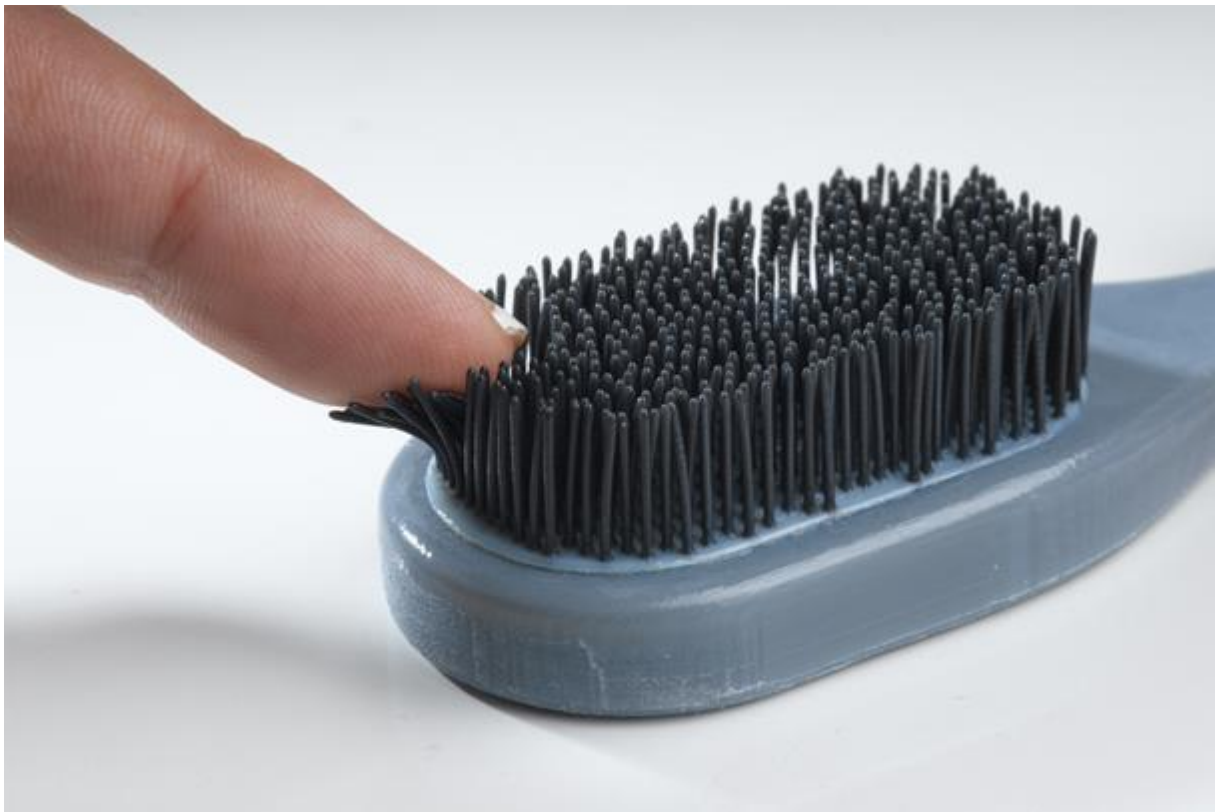
Slika 6. Prototip izrađen polyjet postupkom gdje je kombinirano 2 vrste materijala [16]
