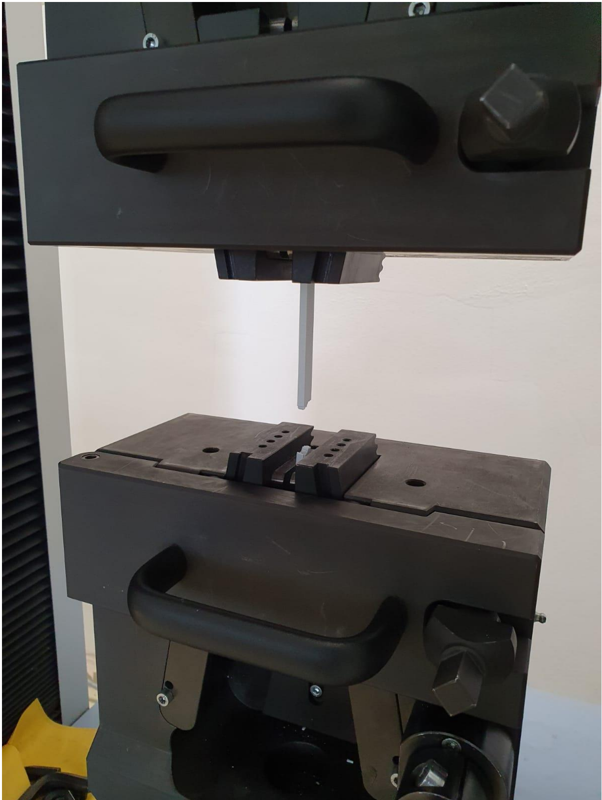
Slika 37. Prikaz ispitne epruvete nakon provedenog ispitivanja
