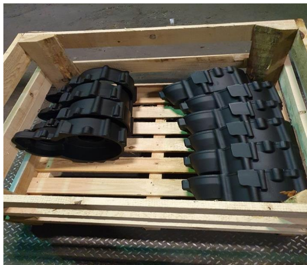
Slika 42.: DANA 104 nakon nanošenja premaza[10]
