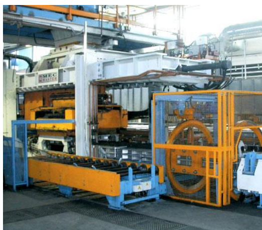
Slika 18.: MM automatska linija za kalupljenje[10]
