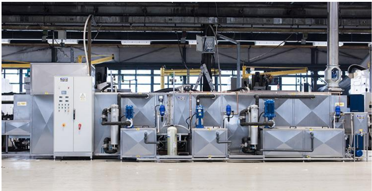
Slika 38.: Linija za pranje gotovih proizvoda u mehaničkoj obradi[10]
