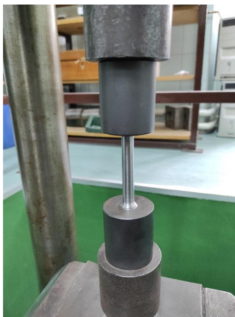
Slika 25. : Postavljanje epruvete u čeljust kidalice
