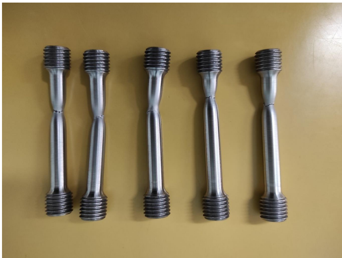
Slika 28. : Prikaz epruveta nakon provedenog statičkog vlačnog ispitivanja
