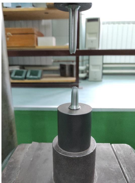
Slika 27. : Epruveta nakon loma
