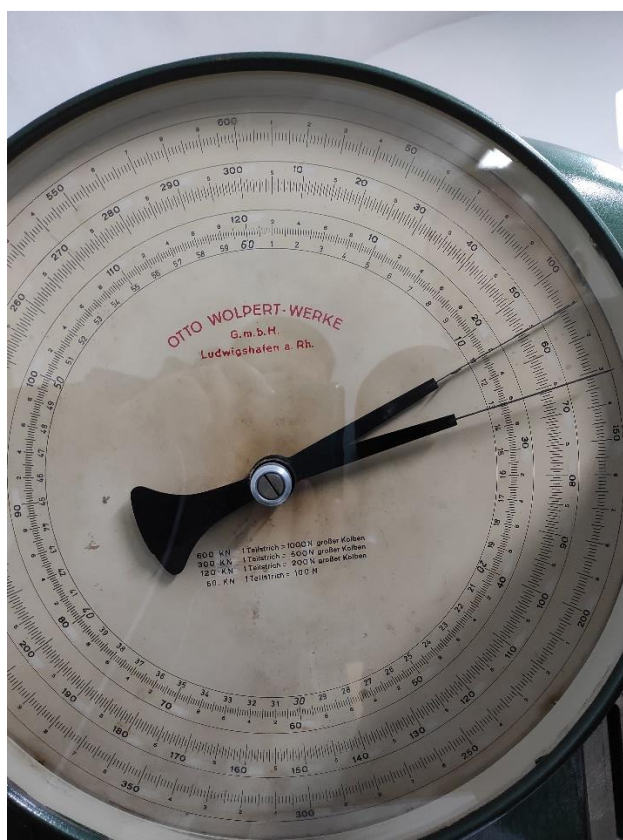
Slika 26. : Mjerenje sile F_m i R_m
