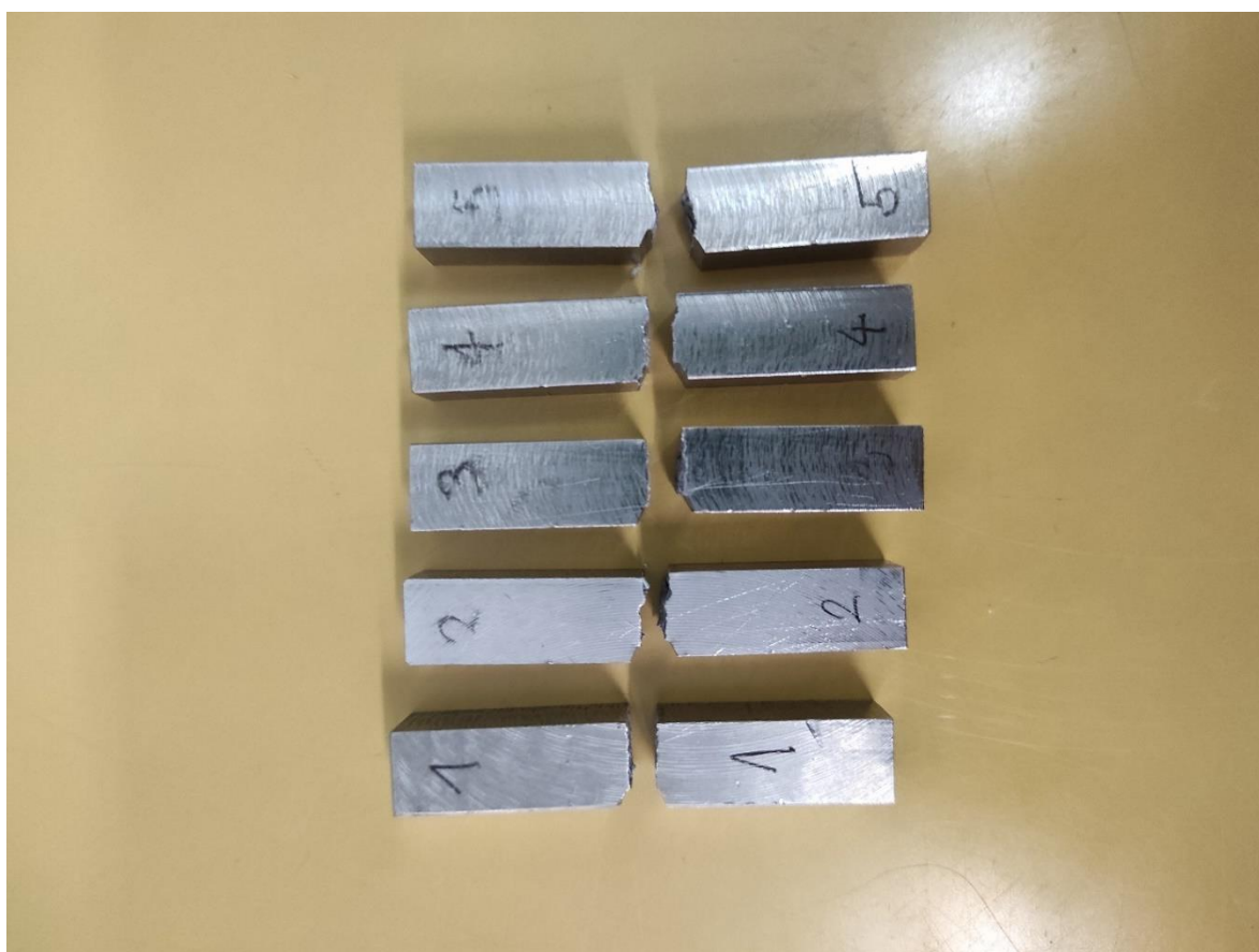
Slika 20. : Prikaz uzoraka nakon provedenog ispitivanja udarnog rada loma
