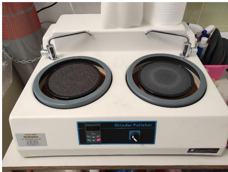
Slika 29. : Uređaj za brušenje i poliranje
