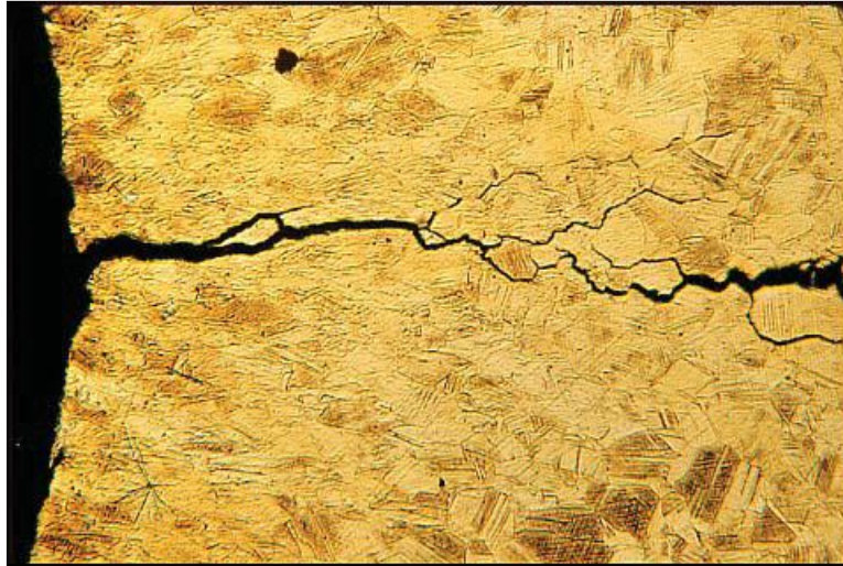
Slika 3. : Mikrostruktura napetosne korozije
