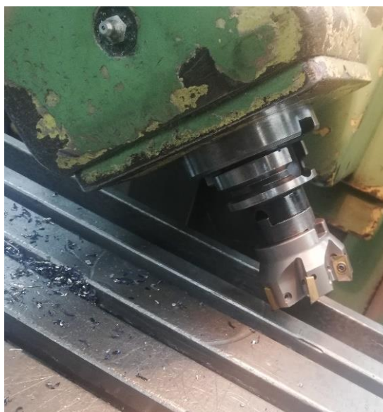
Slika 57. Primjer jedne glodaće glave sa tvrdometalnom pločicama u uporabi na klasičnoj glodalici
