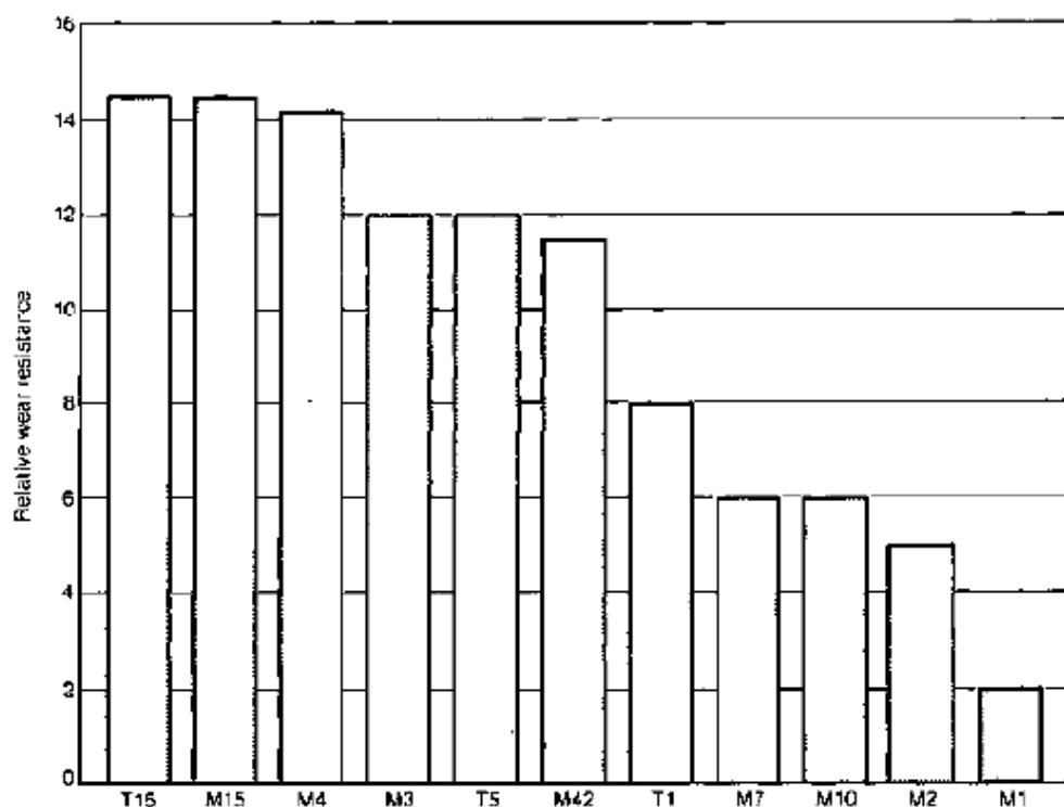
Slika 4. Usporedba relativne otpornosti na trošenje različitih klasa brzoreznih čelika (1)
