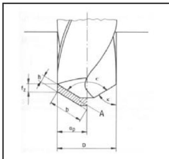
Slika 27. – Presjek reznog dijela A , sa svim varijablama (2)
