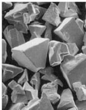
Slika 13. Monokristali volframovog karbida proizvedeni izravnom redukcijom rude volframa (1)
