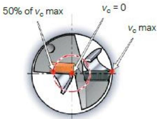
Slika 25. Raspodjela brzine od centra prema rubu reznog dijela (3)
