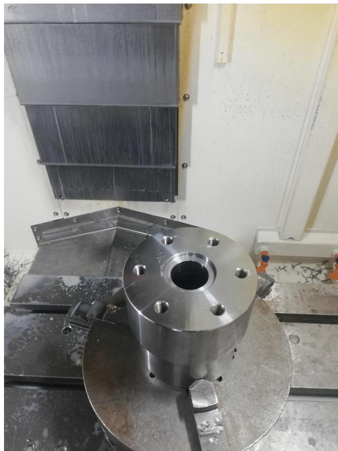
Slika 48. Cilindrični obradak sa 6 provrta
