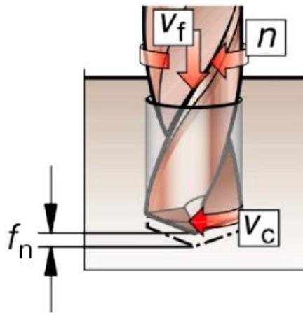
Slika 26. Prikaz glavnih parametara kod operacije bušenja (3)
