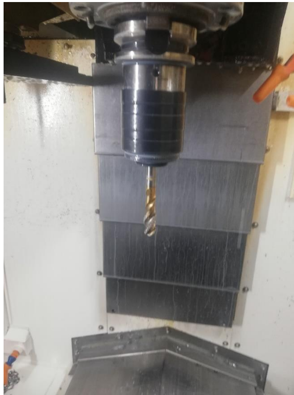
Slika 50. Ureznik HSS-E sa TiN presvlakom
