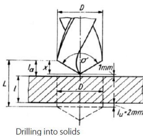
Slika 28. Presjek kod bušenja (2)
