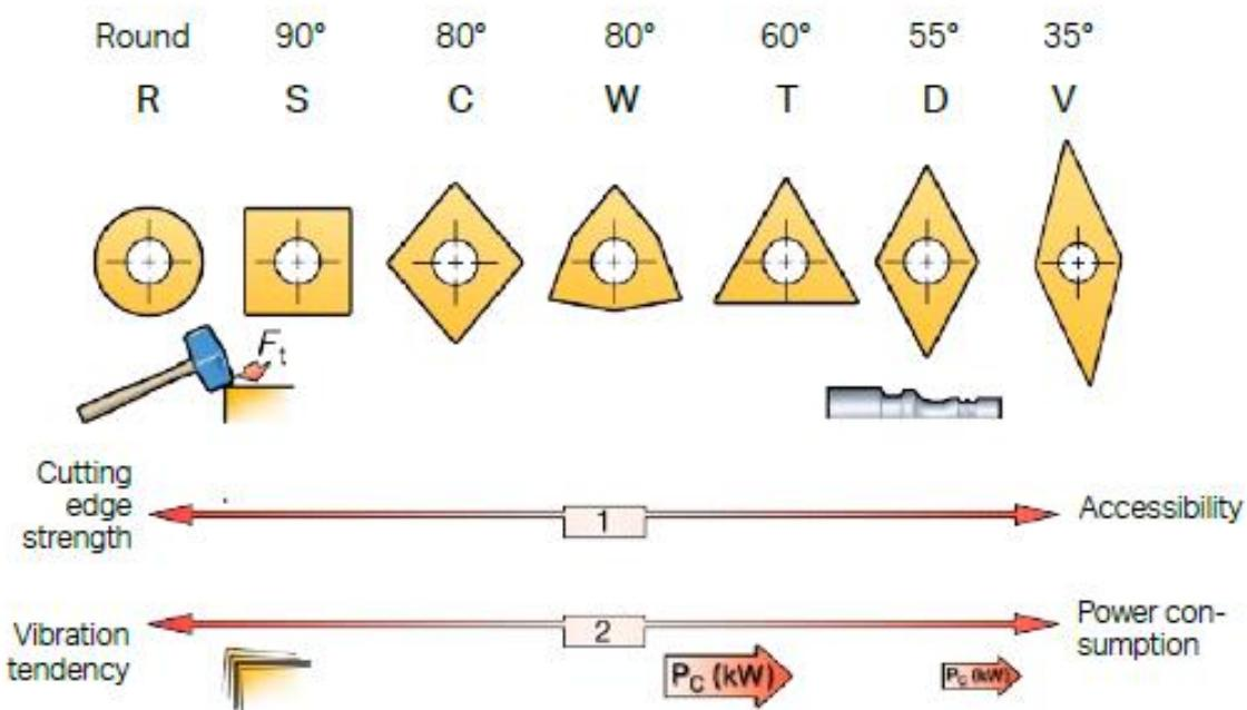
Slika 45. Geometrije pločica za tokarenja prema obliku (3)
