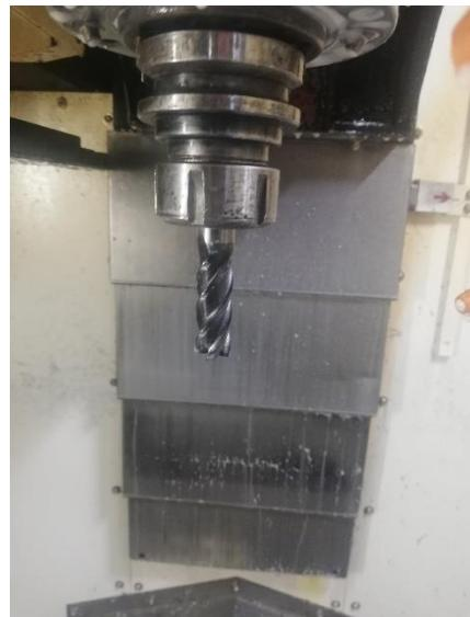
Slika 53. Tvrdometalno glodalo
