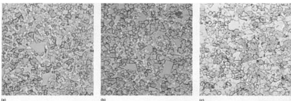
Slika 19. Reprezentativne mikrostrukture volframovog karbida za obradu čelika (1)
