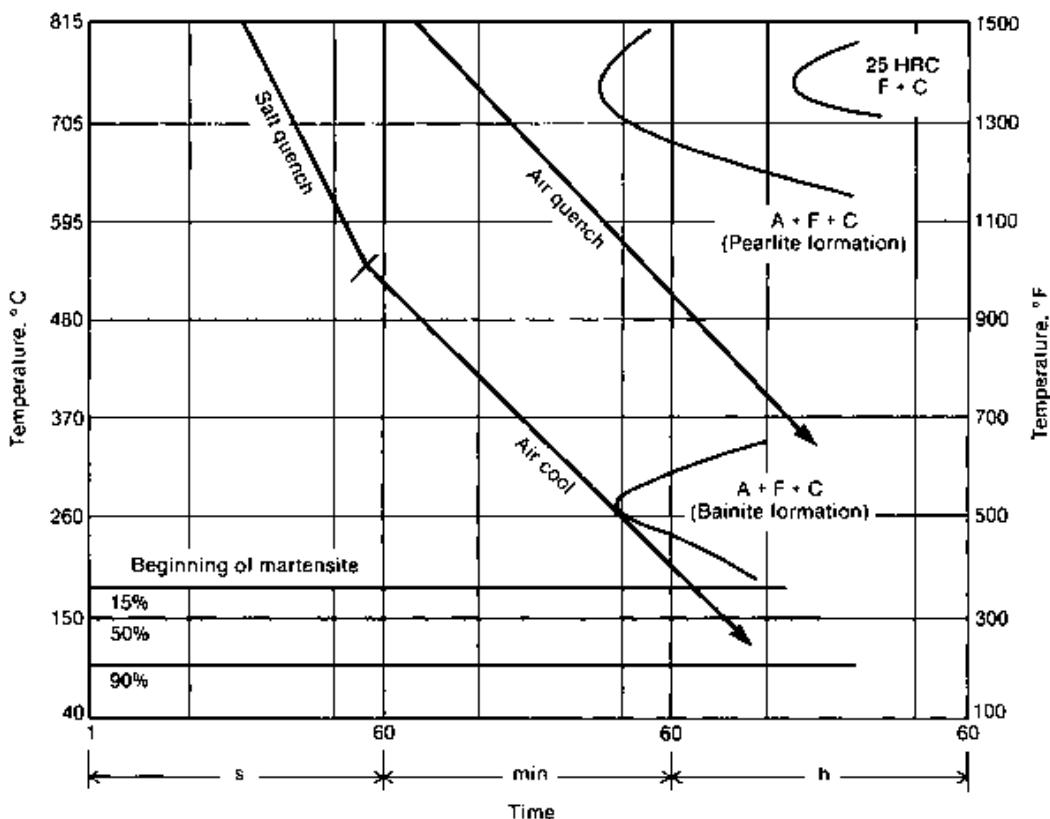
Slika 10. Dijagram vrijeme-temperatura koji pokazuje proces kaljenja(gašenja) za brzorezni alatni čelik M2 koji je bio prije kaljenja odžaren . Temperatura austenitizacije bila je 1230 ° C (2250 ° F), a kritična temperatura bila je 830 ° C (1530 ° F). (1)
