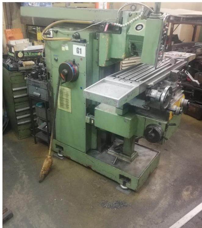
Slika 55. Klasična glodalica(1)
