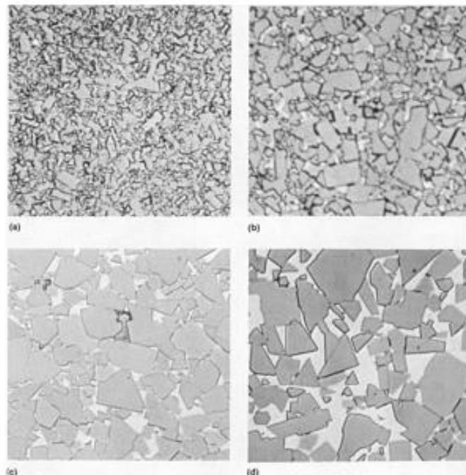
Slika 16. Mikrostrukture jednostavnih legura WC-Co. (1)
