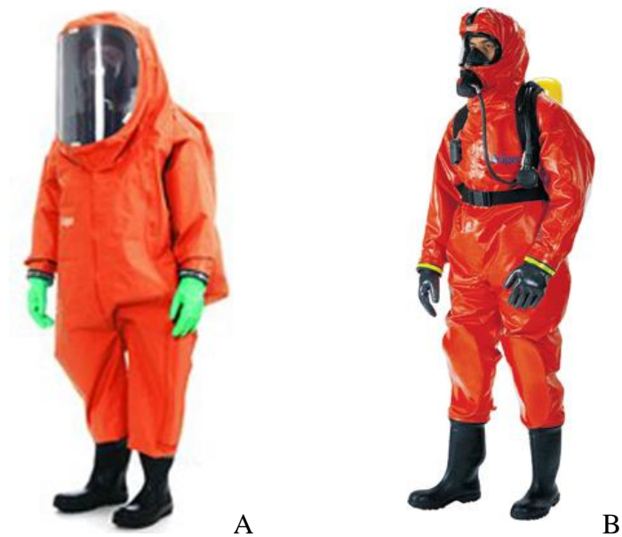
Slika 11: Oblici kemijske zaštitne odjeće 89 ; Tip A , odijelo koje pokriva korisnika zajedno s aparatom za disanje i maskom, sadrži ugrađen zaštitni vizir za oči – veliki panoramski okular. Tip B , odijelo koje pokriva samo korisnika a dišni aparat i maska se nose preko odjeće, oči štiti vizir maske.
