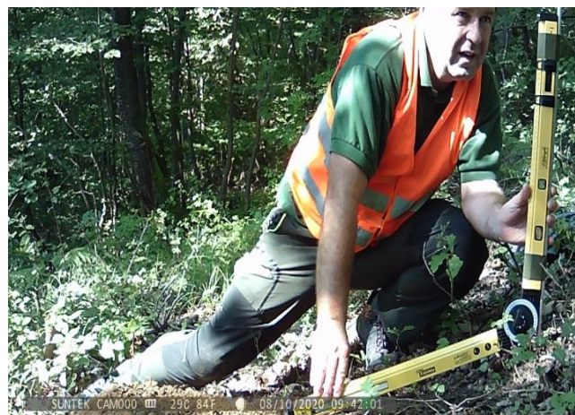
Slika 7. Mjerenje inklinacije na terenu
