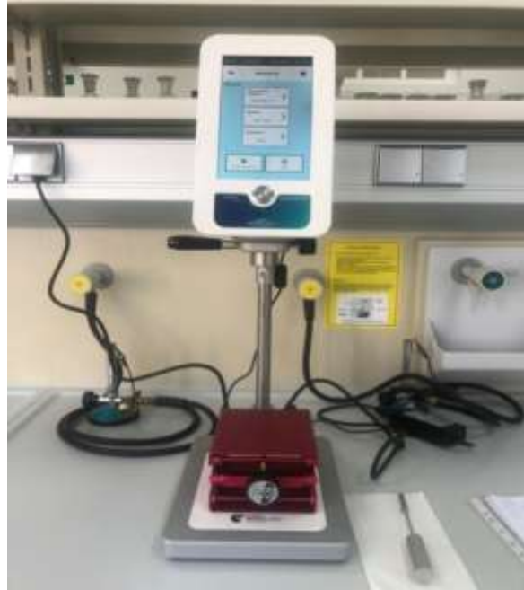
Slika 7. Rotacijski viskozimetar First plus LR.
