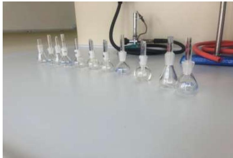
**Slika 6.** Pīknometri korišteni za određivanje gustoće otopina.
