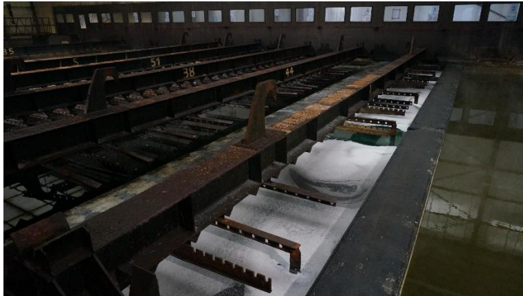
Slika 35. Kade za nagrivanje i ispiranje [7]
