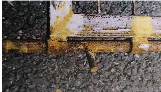
Slika 48. Pokretni dijelovi se ne mogu pocinčavati zajedno [8]
