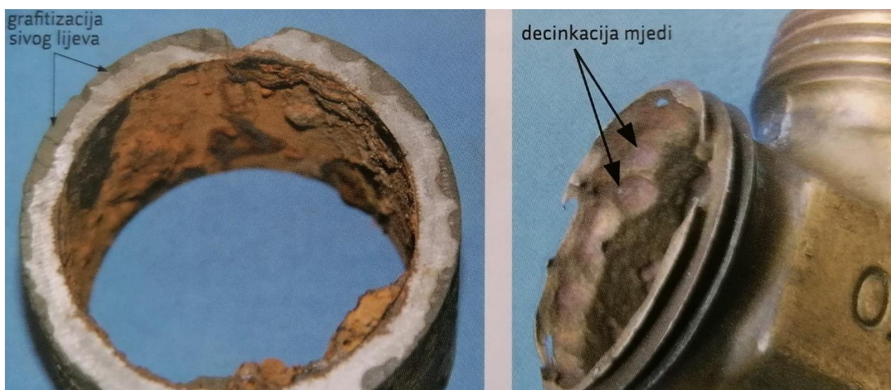
Slika 10. Selektivna korozija [1].
