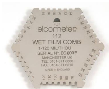
Slika 24. Češalj za mjerenje debljine mokrog filma [5]
