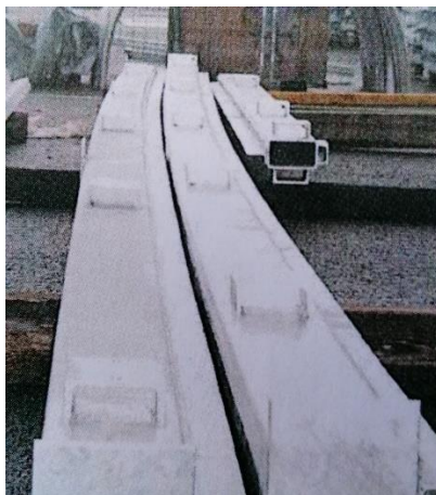
Slika 50. Toplinske deformacije profila zbog asimetričnosti [8]
