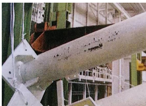
Slika 45. Nedostaci na prevlaci uzrokovani ostacima boje[8]
