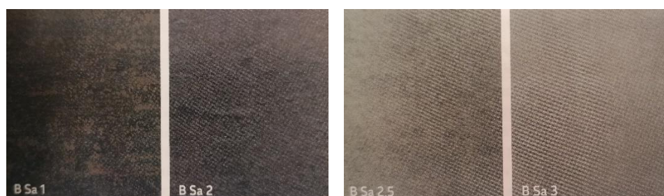
Slika 21. Stanje površine nakon pripreme
