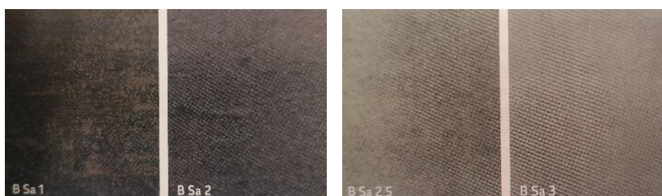
Slika 21. Stanje površine nakon pripreme
