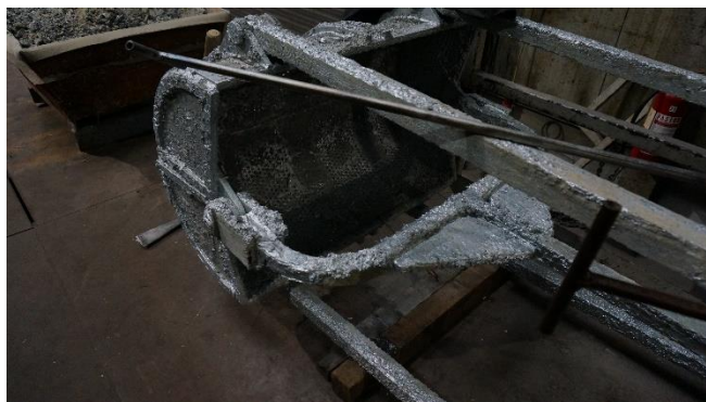
Slika 40. Košara za izvlačenje tvrdog cinka[7]
