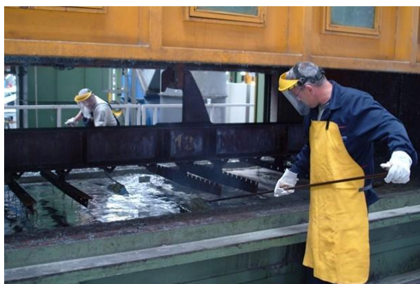
Slika 38. Kada za pocinčavanje prije izvlačenja predmeta [6]
