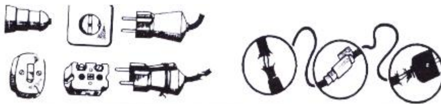
Sl.3.2.4. Neispravne utikačne naprave i električni vodovi
