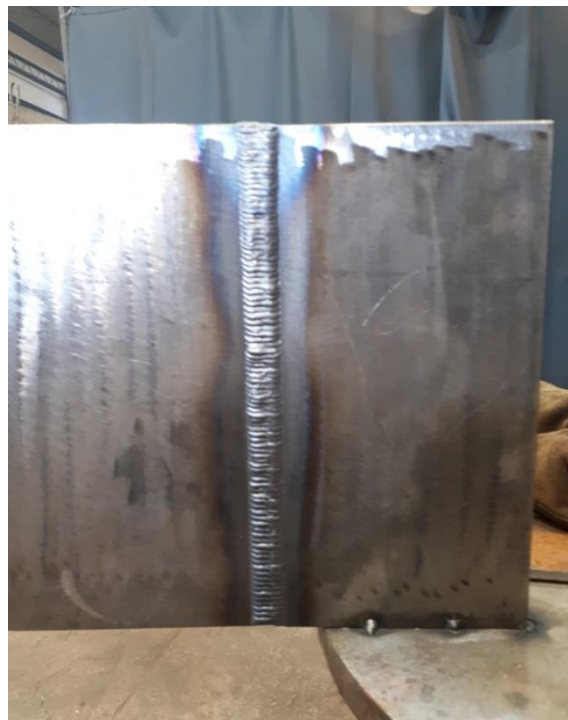
Slika 19. Treći prolaz i kompletno zavareni testni uzorak
