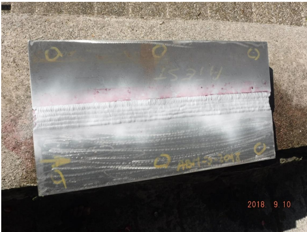
Slika 25. Nanešen razvijač, držati 10-15 min, evidentirati indikacije nakon isteka vremena
