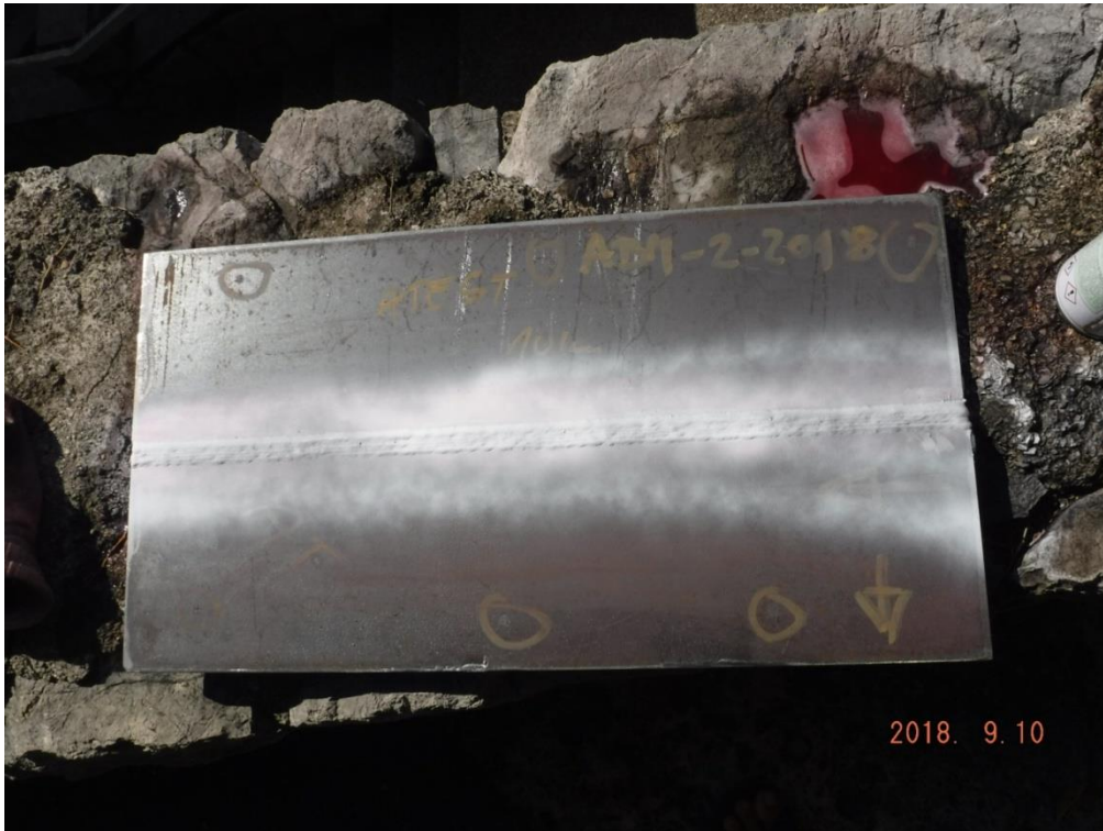
Slika 23. Nanešen razvijlač, držati 10-15 min, evidentirati indikacije nakon isteka vremena
