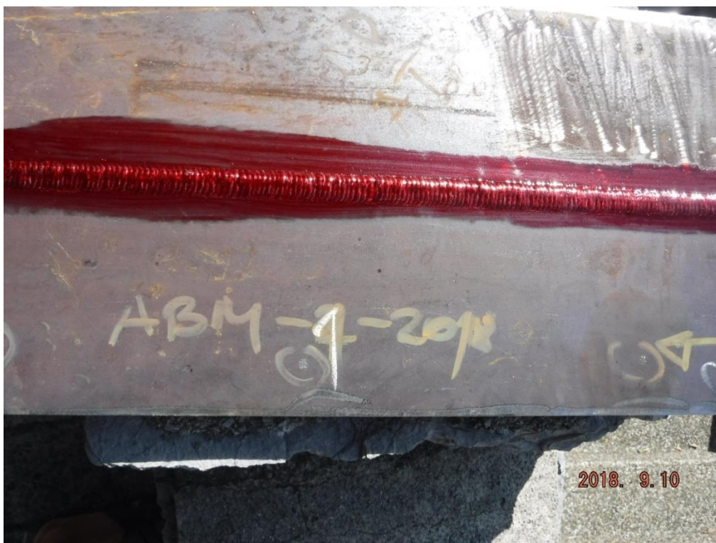
Slika 21. Testni uzorak 2 - Nanešen penetrant, držati 10-15 min.
