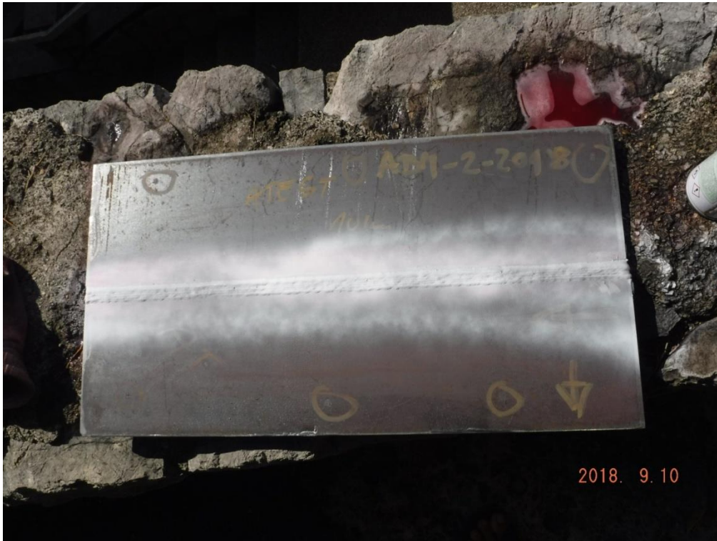
Slika 23. Nanešen razvijač, držati 10-15 min, evidentirati indikacije nakon isteka vremena
