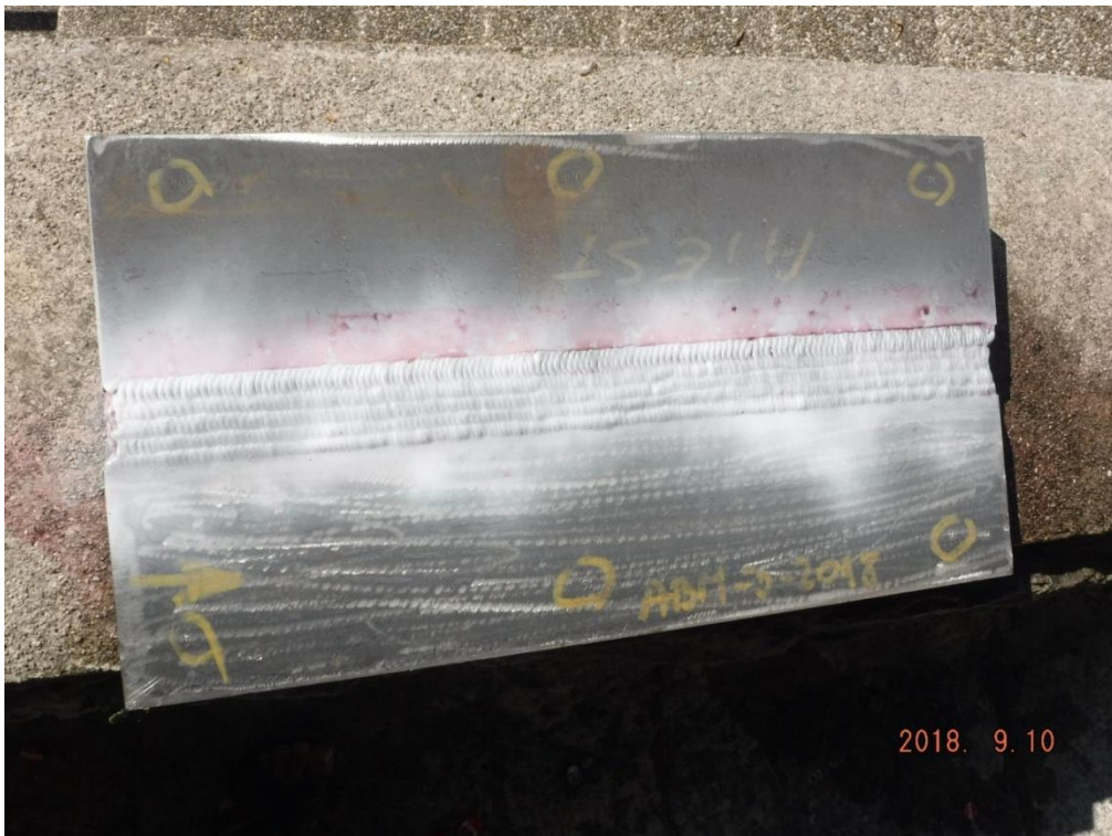
Slika 26. Nanešen razvijač, držati 10-15 min, evidentirati indikacije nakon isteka vremena
