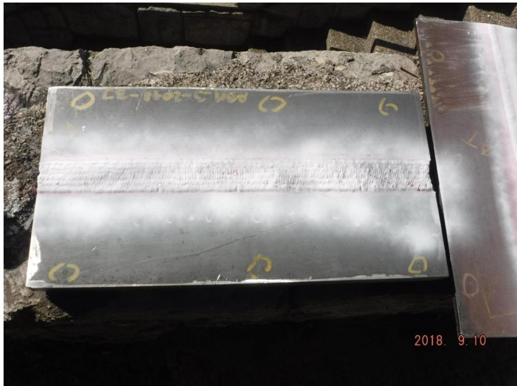
Slika 27. Nanešen razvijač, držati 10-15 min, evidentirati indikacije nakon isteka vremena
