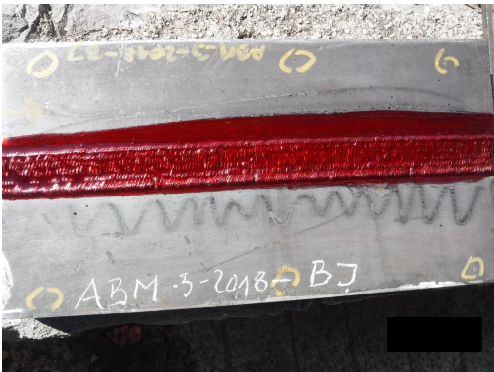
Slika 20. Testni uzorak 1 - Nanešen penetrant, držati 10-15 min.
