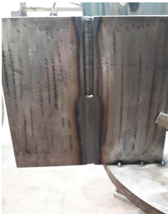
Slika 17. Drugi sloj nanošen odozdo prema gore
