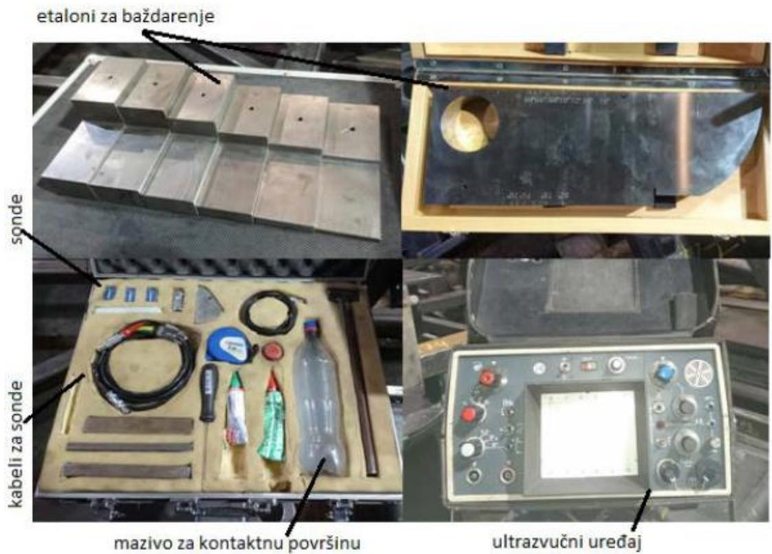
Slika 28. Oprema za ispitivanje ultrazvukom
