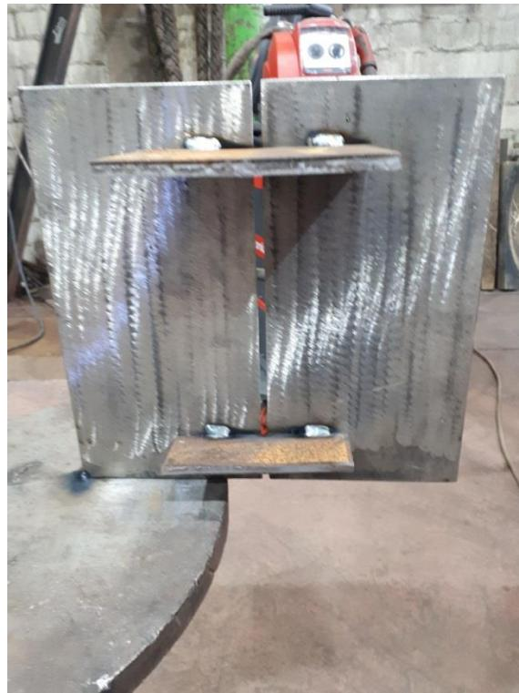
Slika 14. Testni uzorak – pomoćni limovi za održavanje razmaka
