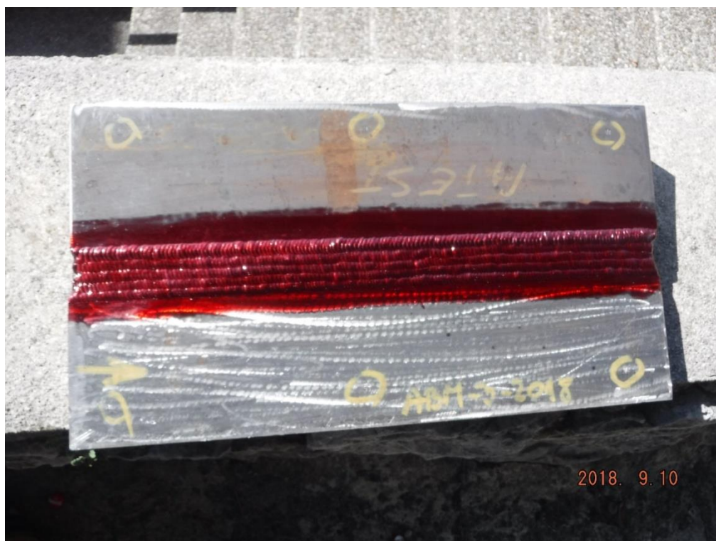
Slika 22. Testni uzorak 3 - Nanešen penetrant, držati 10-15 min.
