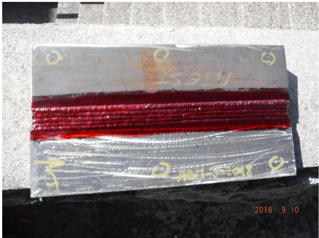
Slika 22. Testni uzorak 3 - Nanešen penetrant, držati 10-15 min.
