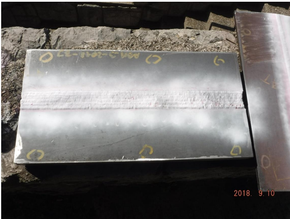
Slika 27. Nanešen razvijlač, držati 10-15 min, evidentirati indikacije nakon isteka vremena
