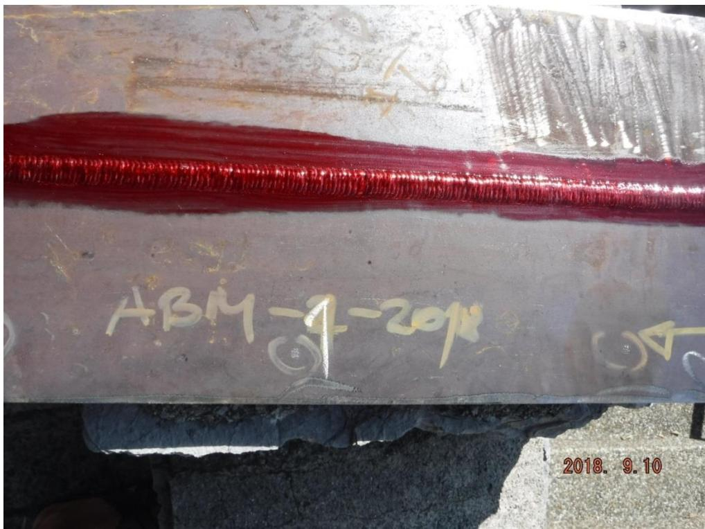
Slika 21. Testni uzorak 2 - Nanešen penetrant, držati 10-15 min.
