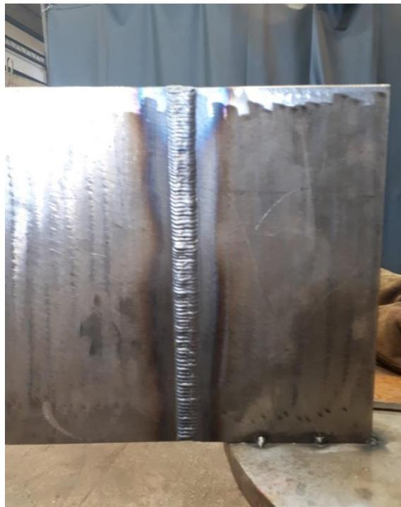
Slika 19. Treći prolaz i kompletno zavareni testni uzorak
