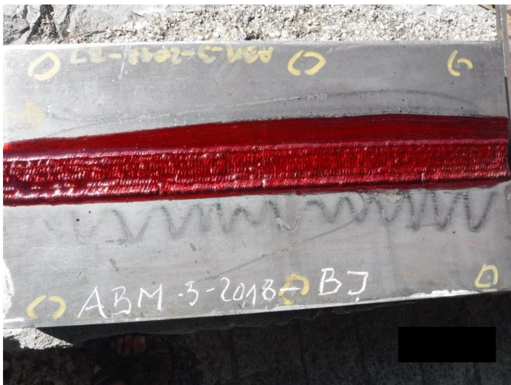
Slika 20. Testni uzorak 1 - Nanešen penetrant, držati 10-15 min.
