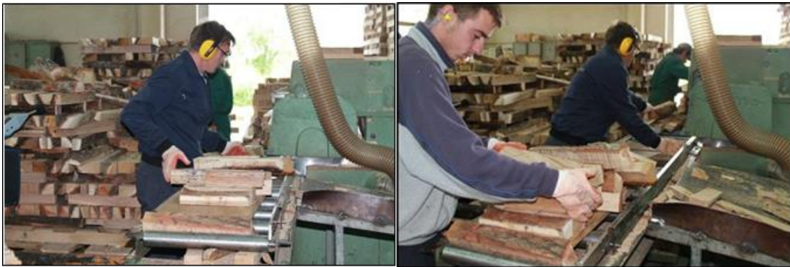
Slika 3: Obrada drva sa većom količinom prašine
