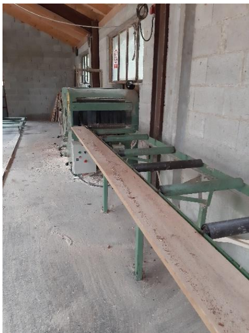
Slika 16: Automatska višelisna kružna pila
