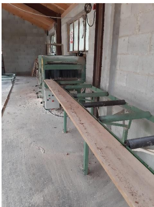
Slika 16: Automatska višelisna kružna pila
