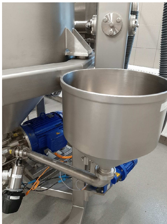
Slika 3. Lijevak za prihvatanje finih praškastih sirovina (emulgatora) (Izvor: D. Novosel).
