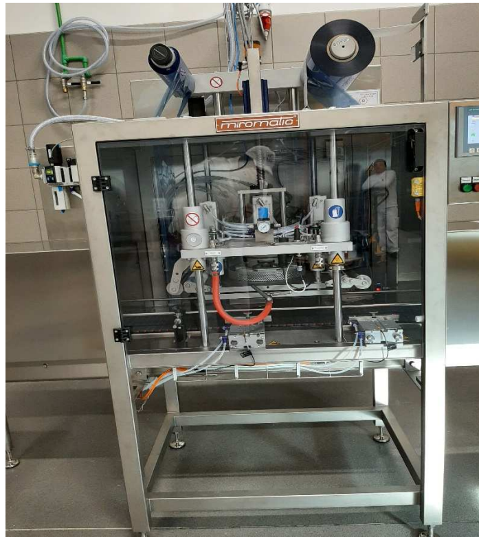
Slika 12. Centralni dio postrojenja za zatvaranje kantica pomoću folije (Izvor: D. Novosel).
