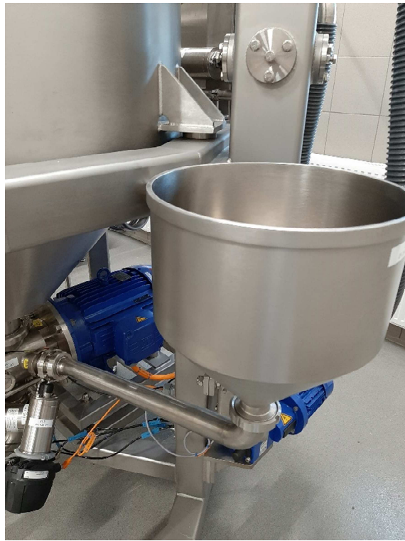
Slika 3. Lijevak za prihvat finih praškastih sirovine (emulgatora) (Izvor: D. Novosel).
