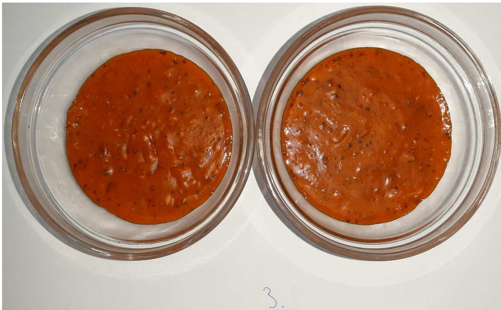
Slika 47. Prikaz kontrole vakuumu za uzorak broj 3. lijevo originalni uzorak, desno uzorak dodatno vakumiran na 0,5 bar pri temperaturi 24°C.
