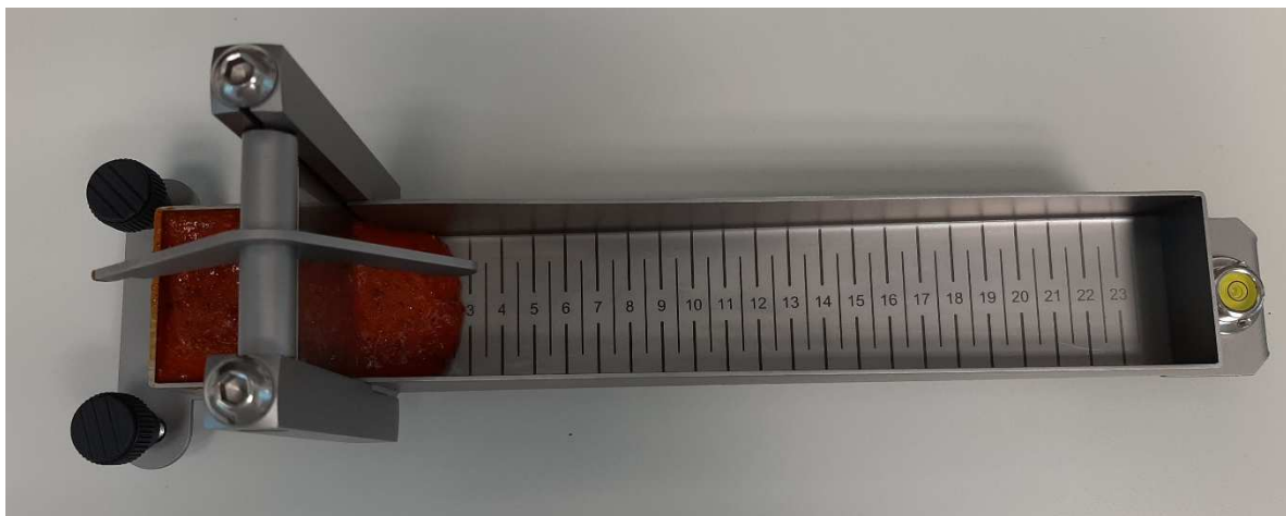
Slika 35. Bostwick konzistometar sa uzorkom (Izvor: D. Novosel).
