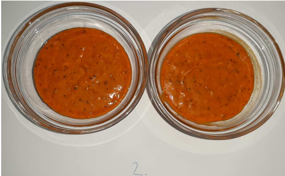
Slika 46. Prikaz kontrole vakuuma za uzorak broj 2. lijevo originalni uzorak, desno uzorak dodatno vakumiran na 0,8 bar pri temperaturi 24°C.
