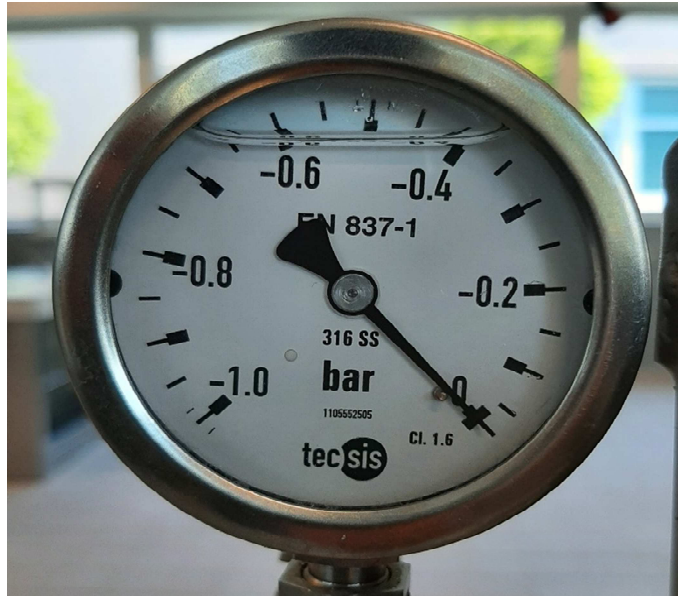
Slika 29. Manometar za praćenje vakuuma (Izvor: D. Novosel)
