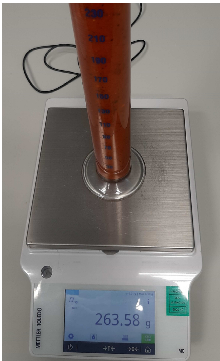
Slika 34. Digitalna vaga tvrtke Mettler Toledo sa preciznošću na 0,00 g, sa uzorkom. (Izvor: D. Novosel).
