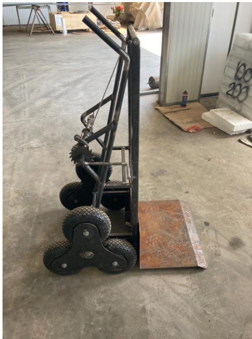
Slika 28. Fizički izrađena ručna kolica za prijevoz tereta do 250 kg
