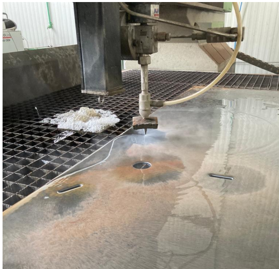
Slika 22. Postupak izrezivanja zvijezda pomoću vodenog mlaza
