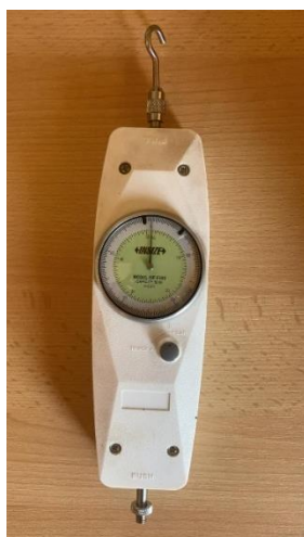
Slika 33. Dinamometar za provođenje ispitivanja (max. 500 N \pm 1%)
