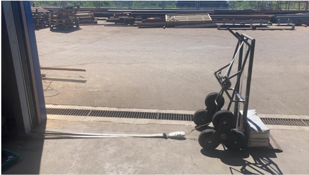
Slika 35. Ispitivanje kolica na betonskoj površini
