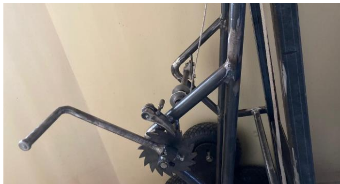
Slika 30. Izvedba sklopive ručke - radni položaj (namatanje)
