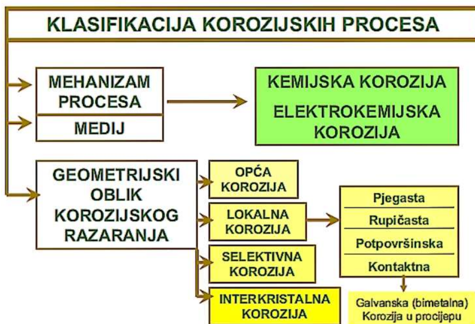
Slika 6. Klasifikacija korozijskih procesa [6].
