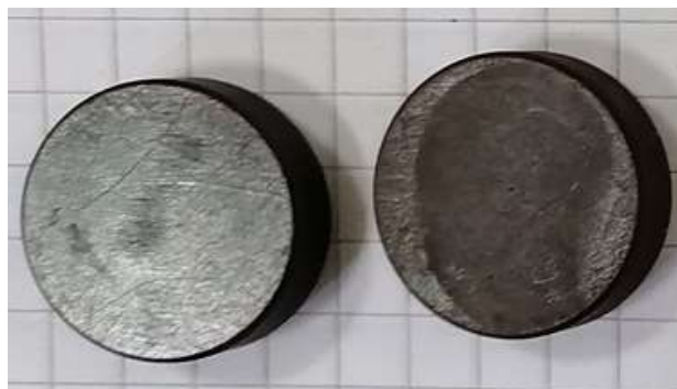
Slika 24. Uzorak poliranog čelika (lijevo) i bruniranog čelika (desno) bez premaza nakon izlaganja 2 h u 10% HCl.
