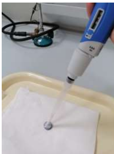
Slika 20. Nanošenje premaza na površinu uzorka čelika.
