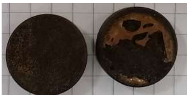
Slika 25. Uzorak poliranog čelika (lijevo) i bruniranog čelika (desno) s premazom 1 nakon izlaganja 10% HCl.
