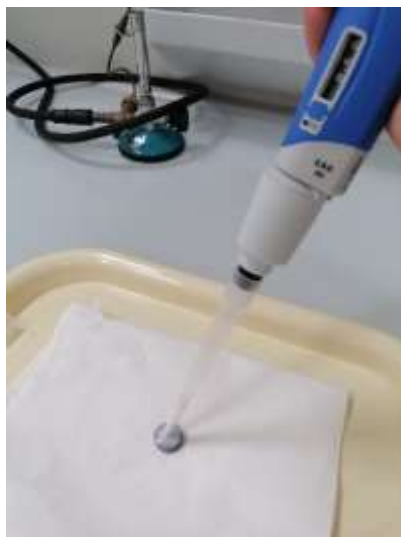
Slika 20. Nanošenje premaza na površinu uzorka čelika.
