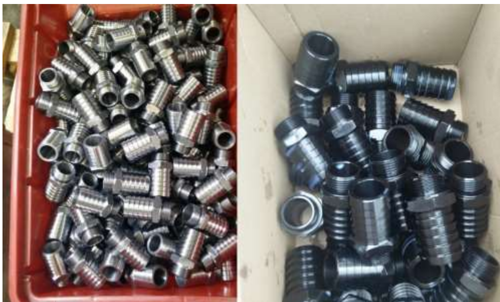
Slika 16. Prikaz strojnih dijelova prije i poslije bruniranja [4].
