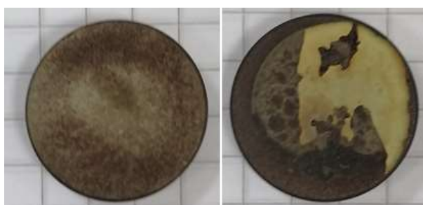
Slika 26. Uzorak poliranog čelika (lijevo) i bruniranog čelika (desno) s premazom 2 nakon izlaganja 10% HCl.
