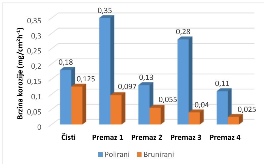
**Slika 23.** Brzine korozije uzorka čelika u 10% otopini solne kiseline pri 25°C.
