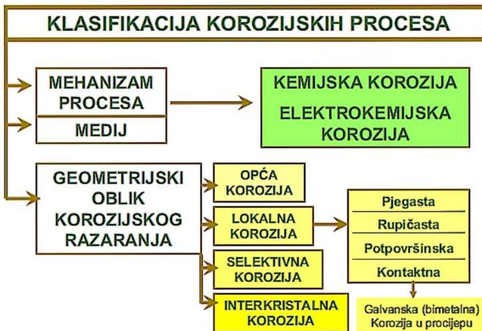
**Slika 6.** Klasifikacija korozijskih procesa [6].
