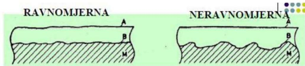
**Slika 7.** Prikaz ravnomjerne i neravnomjerne opće korozije
