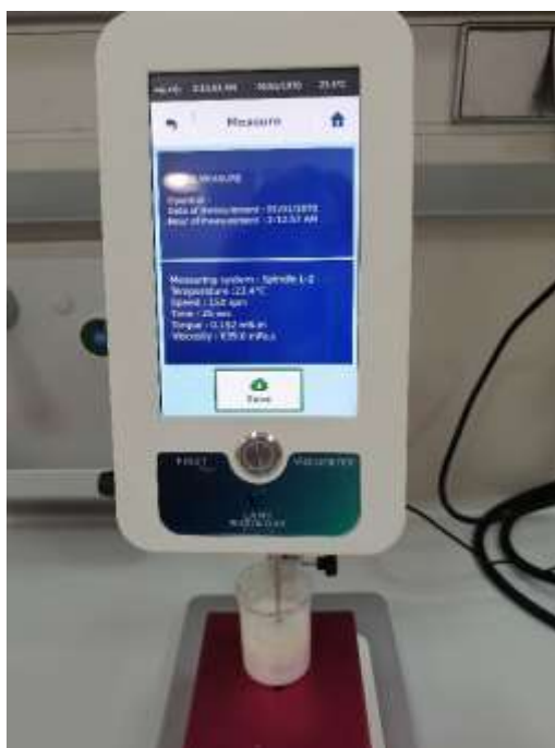
Slika 19. Mjerenje viskoznosti rotacijskim viskozimetrom (Izvor: I. Štiglić).
