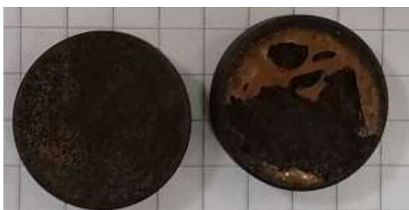
Slika 25. Uzorak poliranog čelika (lijevo) i bruniranog čelika (desno) s premazom 1 nakon izlaganja 10% HCl.
