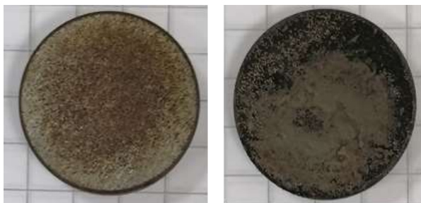
Slika 27. Uzorak poliranog čelika (lijevo) i bruniranog čelika (desno) s premazom 3 nakon izlaganja 10% HCl.
