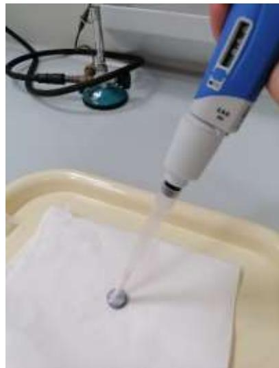
**Slika 20.** Nanošenje premaza na površinu uzorka čelika.
