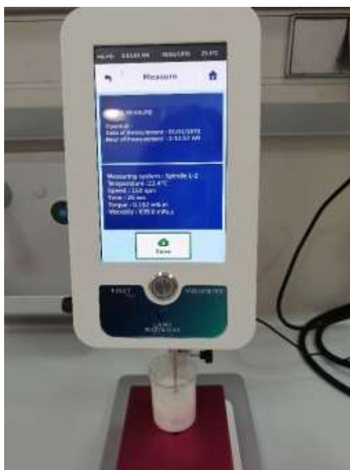
Slika 19. Mjerenje viskoznosti rotacijskim viskozimetrom (Izvor: I. Štiglić).
