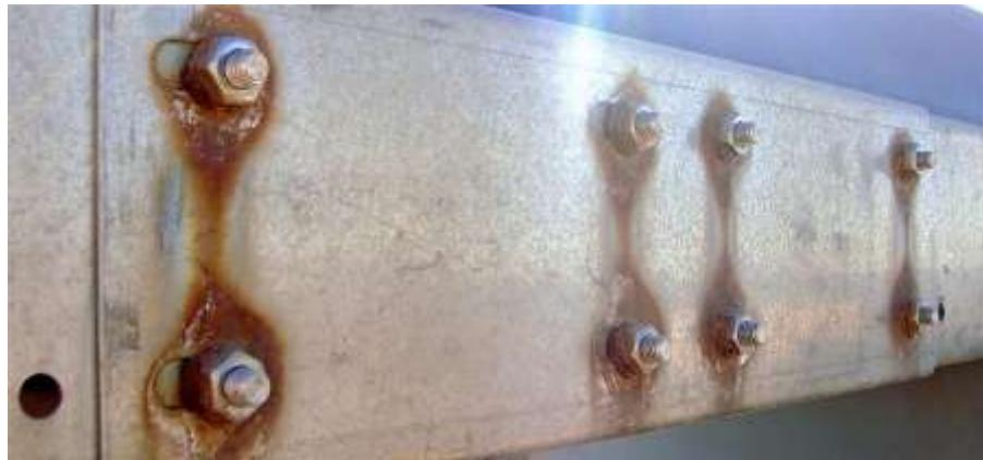
**Slika 8.** Primjer galvanske korozije
