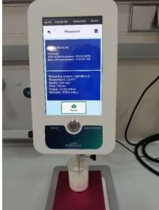
**Slika 19.** Mjerenje viskoznosti rotacijskim viskozimetrom (Izvor: I. Štiglić).
