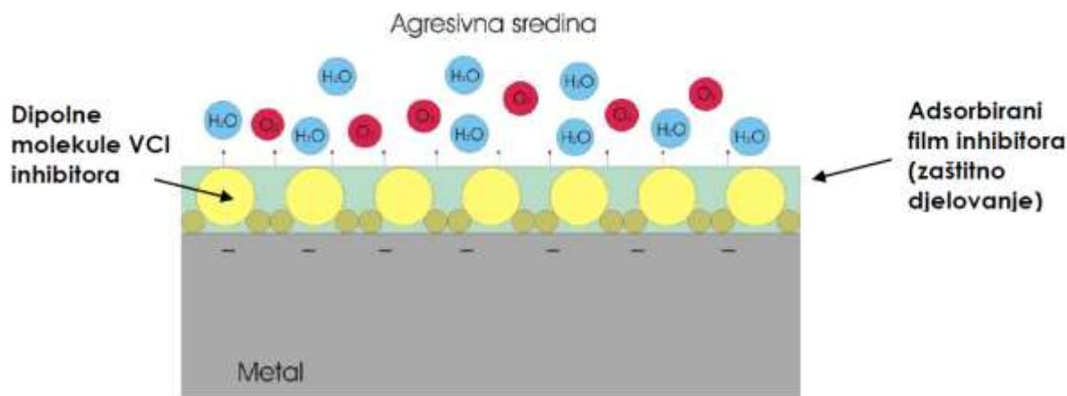
**Slika 15.** Mehanizam djelovanja parnofaznog inhibitora korozije [3].
