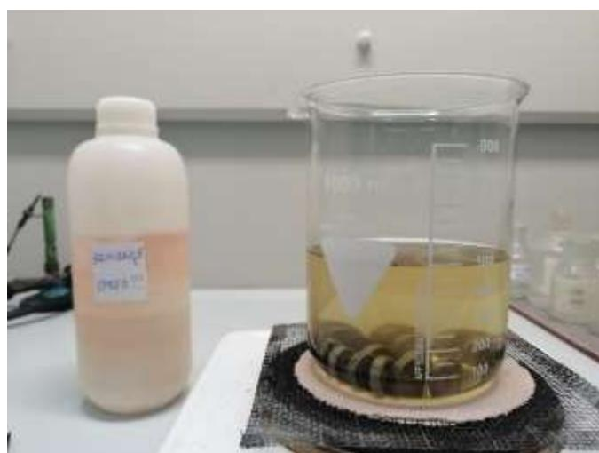
Slika 18. Provođenje postupka bruniranja uzorka čelika (Izvor: I. Štiglić).
