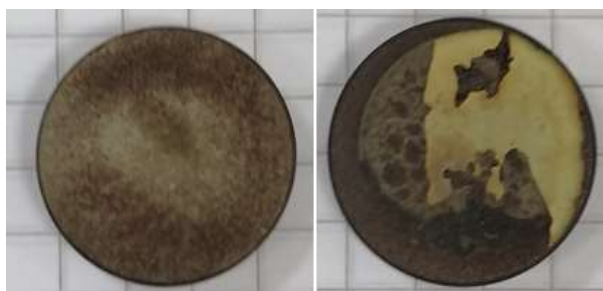
Slika 26. Uzorak poliranog čelika (lijevo) i bruniranog čelika (desno) s premazom 2 nakon izlaganja 10% HCl.
