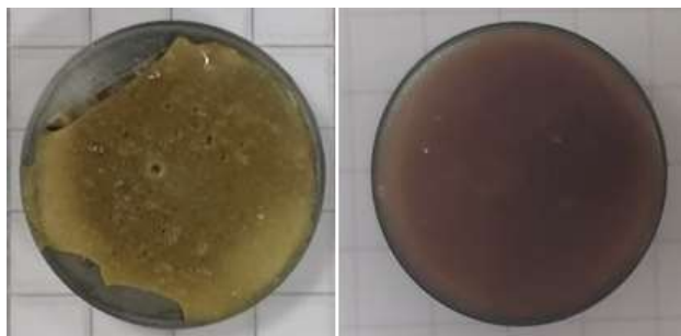
Slika 28. Uzorak poliranog čelika (lijevo) i bruniranog čelika (desno) s premazom 4 nakon izlaganja 10% HCl.
