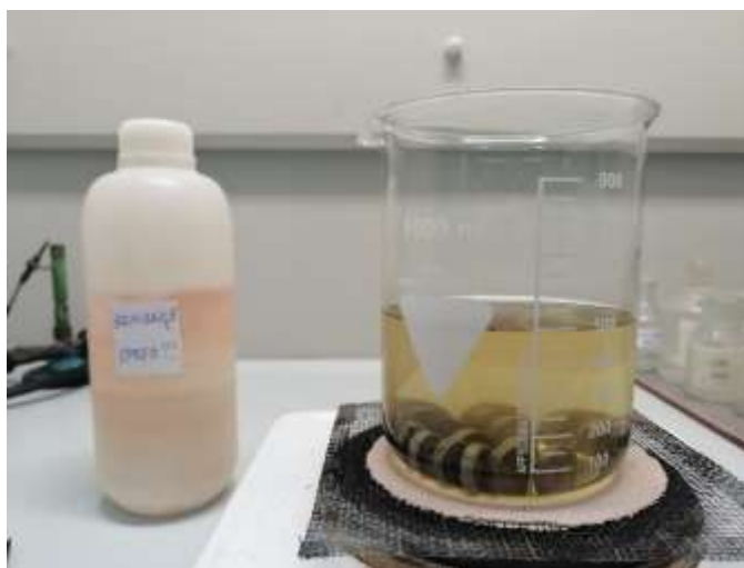
Slika 18. Provođenje postupka bruniranja uzoraka čelika (Izvor: I. Štiglić).
