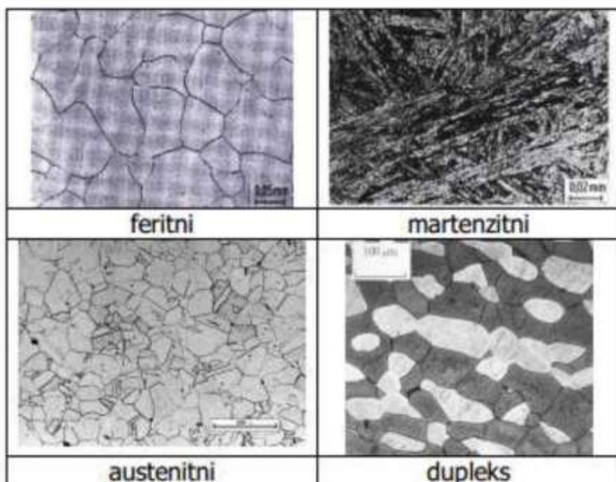
**Slika 4.** Prikaz mikrostruktura pojedinih grupa čelika [3].
