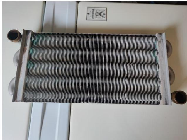
Slika 4: Primarni izmjenjivač topline
