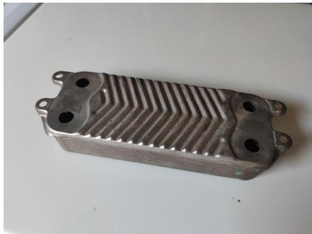
Slika 5: Sekundarni izmjenjivač topline
