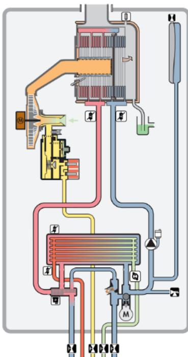
Slika 15 : Predodžba hidrauličke sheme kondenzacijskog uređaja
