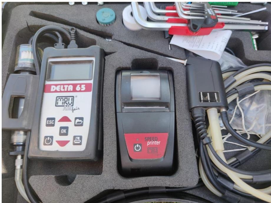
Prilog 7: Aparat za mjerenje izlaznih plinova
