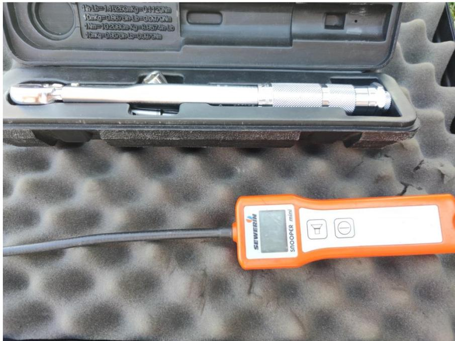
Prilog 6: Detektor za ispitivanje plina i moment ključ
