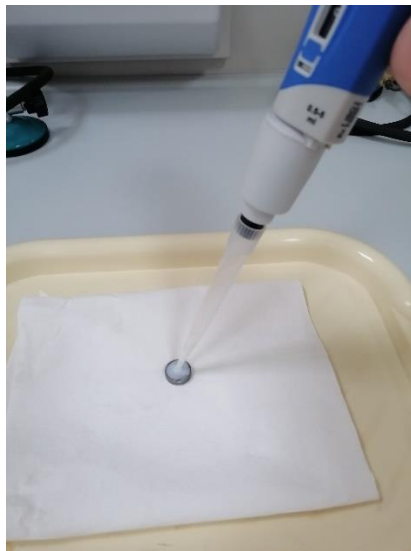
Slika 25: Nanošenje premaza na površinu uzorka čelika
