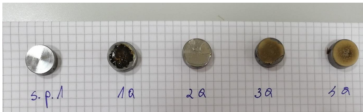
Slika 31: Uzorci poliranog čelika nakon 2h djelovanja 5% otopine HCl
