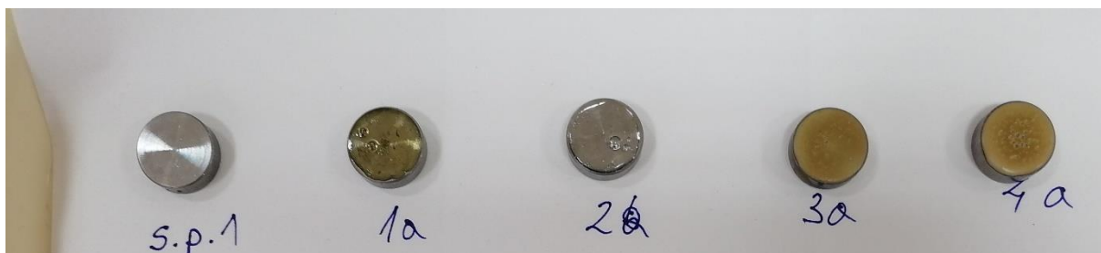
Slika 28: Uzorci čelika prije (sp1-polirani) i nakon nanošenja i sušenja premaza 1 (1a), premaza 2 (2a), premaza 3 (3a) i premaza 4 (4a)
