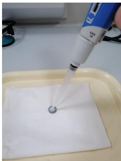
*Slika 25: Nanošenje premaza na površinu uzorka čelika*
