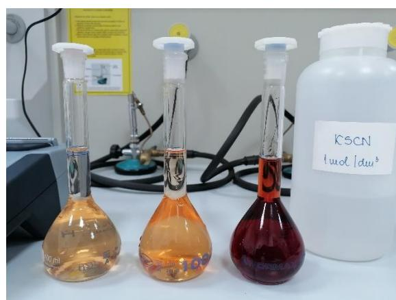
Slika 27: Pripremljene otopine za određivanje sadržaja željeza spektrofotometrijski
