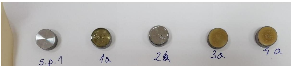
Slika 28: Uzorci čelika prije (sp1-polirani) i nakon nanošenja i sušenja premaza 1 (1a), premaza 2 (2a), premaza 3 (3a) i premaza 4 (4a)
