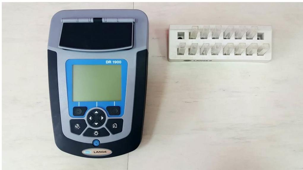
Slika 26: Prijenosni spektrofotometar Hach Lange
