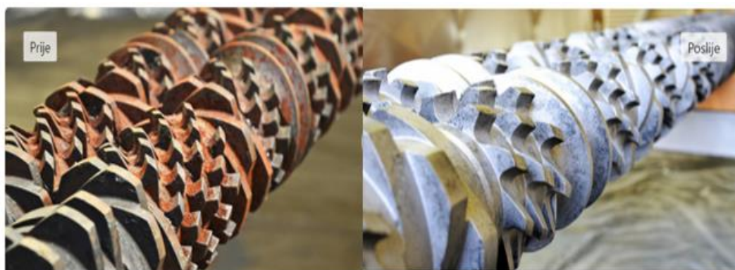
Slika 21: Strojni dio prije i poslije pjeskarenja [28]
