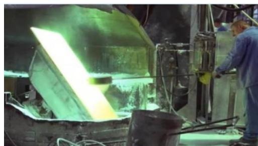
Slika 13: Postupak emajliranja kade od lijevanog željeza [20]
