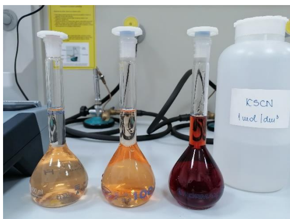
Slika 27: Pripremljene otopine za određivanje sadržaja željeza spektrofotometrijski
