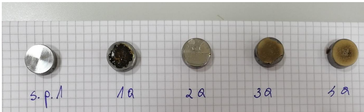
Slika 31: Uzorci poliranog čelika nakon 2h djelovanja 5% otopine HCl
