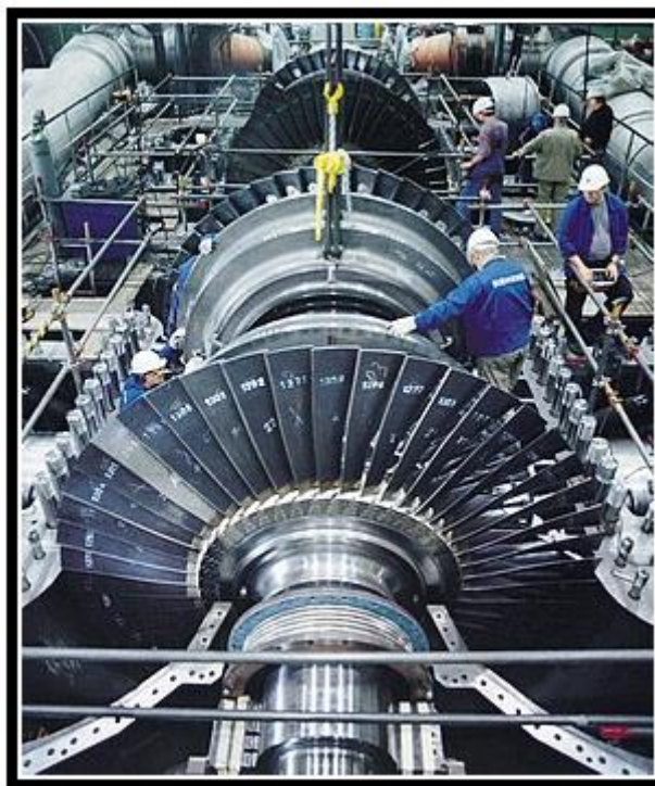
Slika 1. Parna turbina s otvorenim kućištem [1.]
