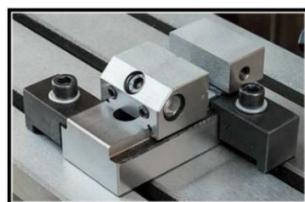
Slika 43. Strojne stezaljke (tamno sivi elementi)
