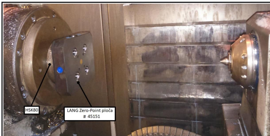
Slika 58. Sklop HSK80+LANG Zero-Point ploče br. 45151
