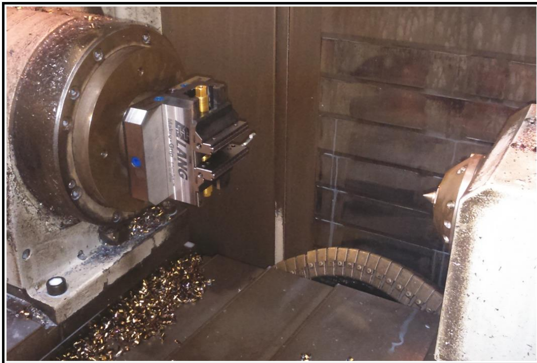
Slika 37. HSK80 + LANG Zero-Point u stroju
