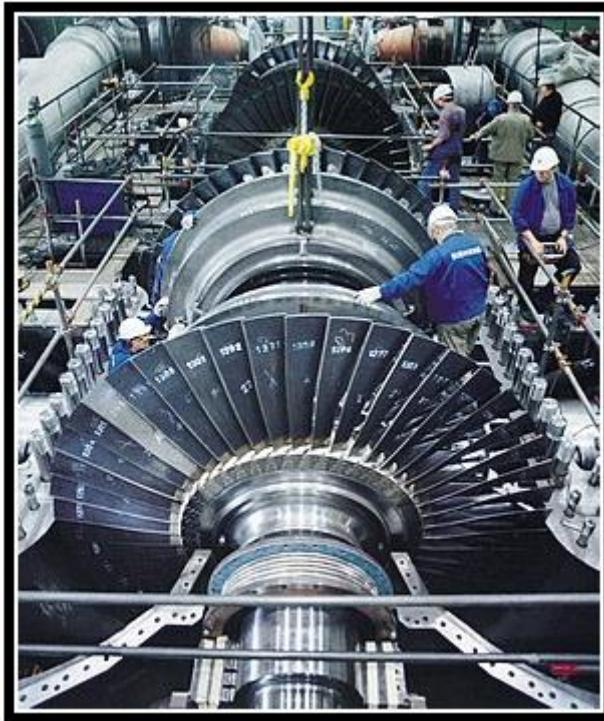
Slika 1. Parna turbina s otvorenim kućištem [1.]
