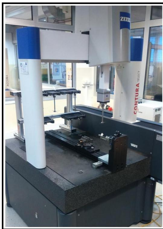
Slika 124. Naprava za mjerjenje na CMM uređaju – lopatica u procesu mjerjenja - 2
