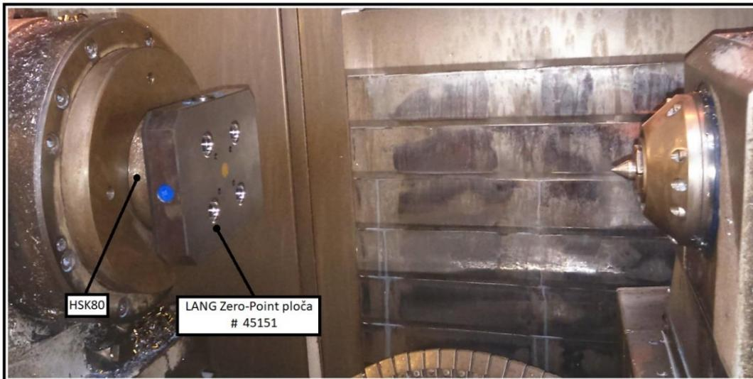
Slika 58. Sklop HSK80+LANG Zero-Point ploče br. 45151
