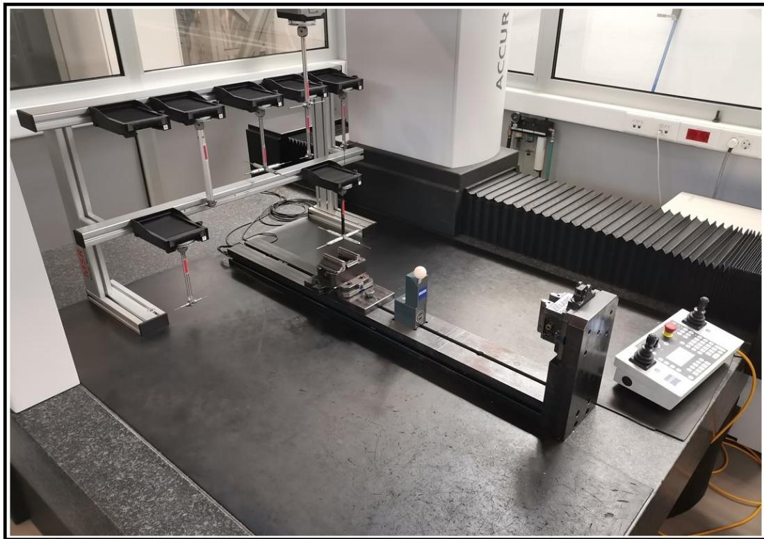
Slika 40. Izgled poboljšane naprave na CMM uređaju
