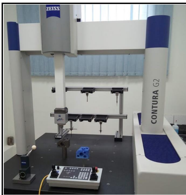
Slika 11. Zeiss CMM mjerni uređaj [11.]
