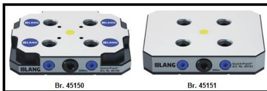
Slika 13. Zero-Point ploče kao poveznica sa svim fazama procesa [10.]
