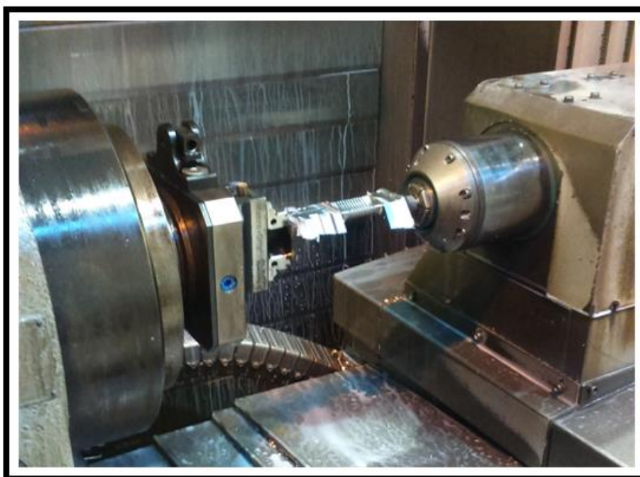
Slika 122. Naprava za stezanje na stroju s obrađenom lopaticom - 2
