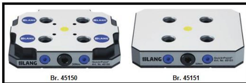
Slika 13. Zero-Point ploče kao poveznica sa svim fazama procesa [10.]
