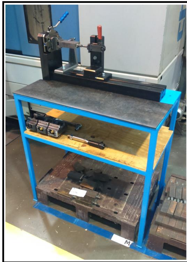
Slika 120. Završni sklop Zero-Point naprave i stola (Faza 1)
