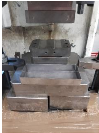
Slika 54 Predodžba alata za ravnjanje platine povlakača
