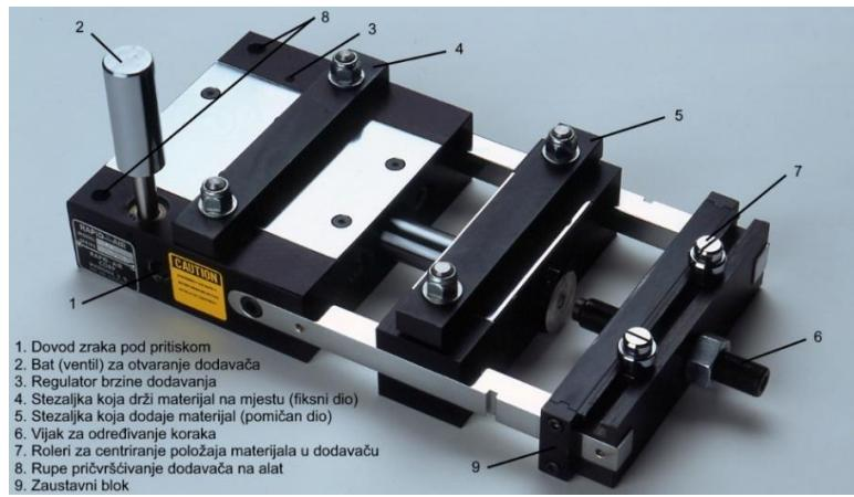
Slika 44 Predodžba pneumatskog dodavača. Izvor [16]
