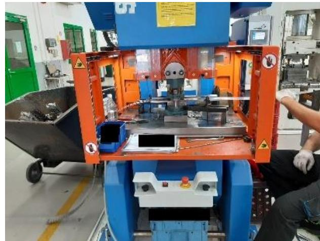
Slika 52 Predodžba ručnog posmaka trake.
