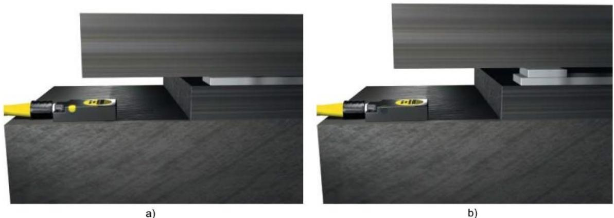
Slika 48 Predodžba: a) senzor mjeri položaj alata i b) detektira promjenu. Izvor [14]
