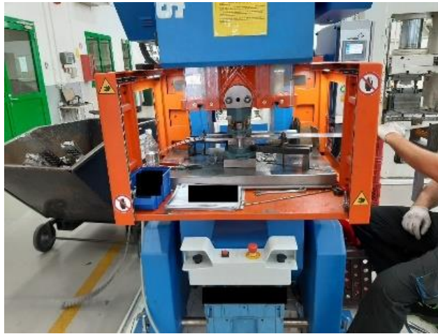
Slika 52 Predodžba ručnog posmaka trake.
