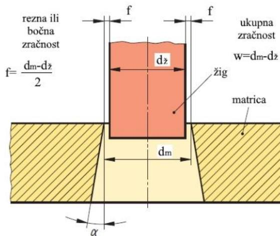
Slika 15 Predodžba rezne zračnosti. Izvor [7].
