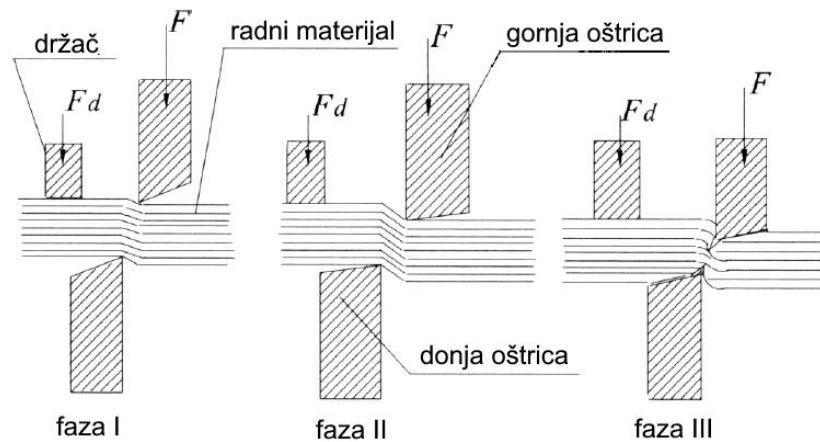
Slika 8 Shematski prikaz procesa rezanja. Izvor [5].
