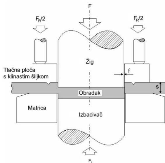
Slika 27 Predodžba sila finog štancanja. Izvor [13]
