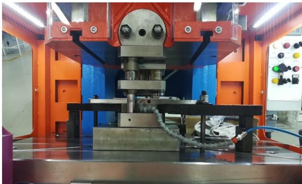
Slika 59 Predodžba ispuhivanja platina kroz alat.
