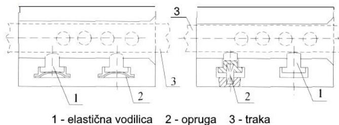
Slika 42 Predodžba konstrukcije elastičnih vodilica materijala. Izvor [5]
