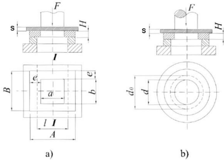
Slika 33 Shematski prikaz za računanje dimenzije matrice. Izvor [5]
