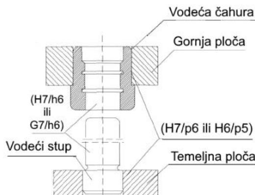
Slika 39 Predodžba vodećeg stupa i vodeće čahure. Izvor [5]
