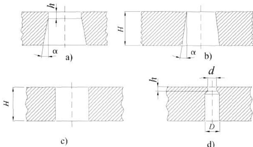
Slika 32 Predodžba četiri oblika presjeka otvora matrice. Izvor [5]
