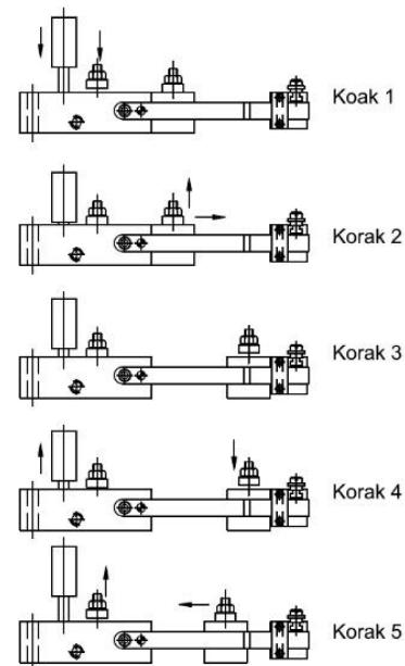
Slika 45 Predodžba načina rada pneumatskog dodavača. Izvor[17]
