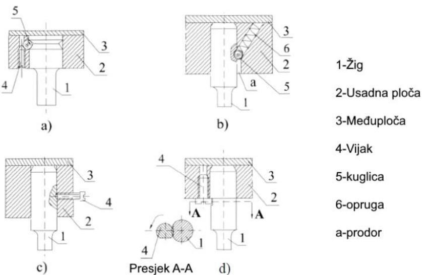
Slika 37 Predodžba konstrukcija žigova za brzu izmjenu. Izvor [5]
