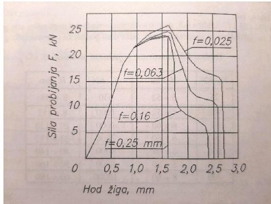
Slika 16 Predodžba dijagrama za određivanje zazora. Izvor [2].
