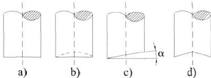
Slika 34 Predodžba četiri vrste geometrije rezne površine: a) ravna, b) udubljena, c) kosa, i d) dvije kosine. Izvor [5]
