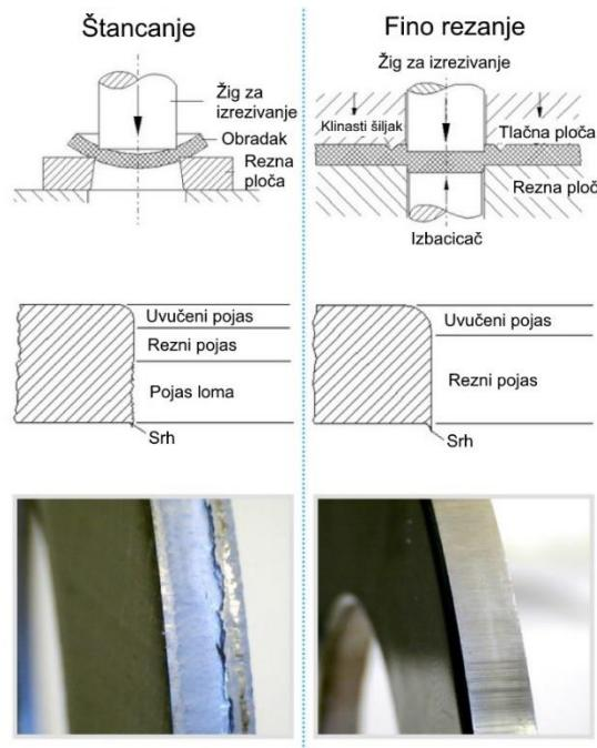
Slika 26 Predodžba razlike štancanja i finog rezanja. Izvor [12]
