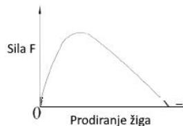
Slika 17 Predodžba sile prosijecanja ili probijanja. Izvor [5].
