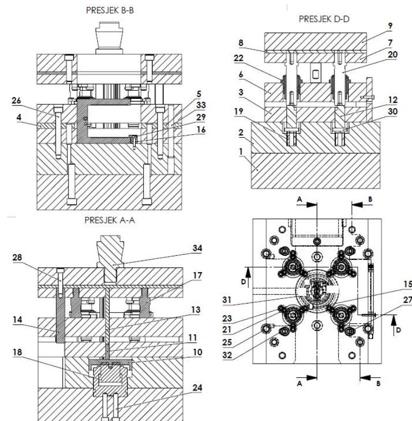
Slika 55 Predodžba shematskog prikaz novog alata za štancanje platine povlakača
