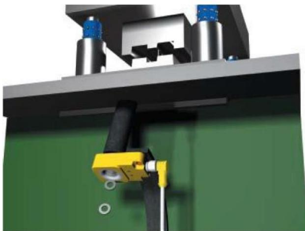
Slika 47 Predodžba senzora za detekciju izbačenih komada. Izvor [14]
