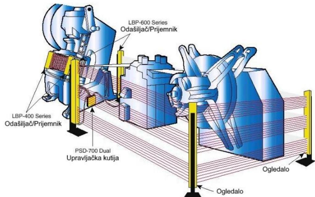
Slika 49 Predodžba zaštite cijelog automatiziranog procesa štancanja. Izvor [15]
