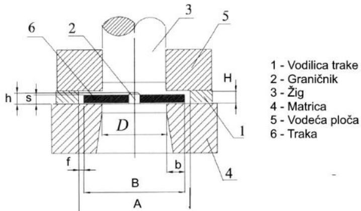
Slika 43 Predodžba konstrukcije s fiksnim vodećim letvama. Izvor [5]
