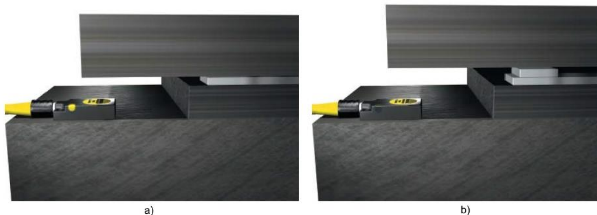
Slika 48 Predodžba: a) senzor mjeri položaj alata i b) detektira promjenu. Izvor [14]
