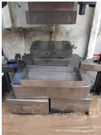
Slika 54 Predodžba alata za ravnjanje platine povlakača
