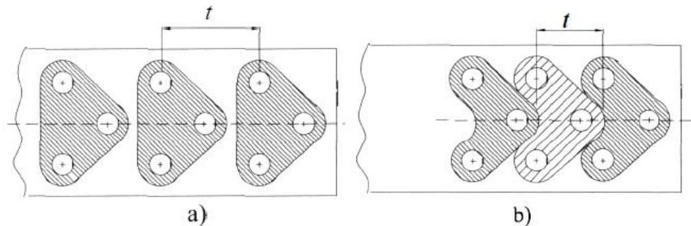
Slika 23 Predodžba uštede materijala prilagođivanjem tehnike štancanja izmjenjivanjem rasporeda rezanja: a) izvorni, b) izmjenjen. Izvor [5]
