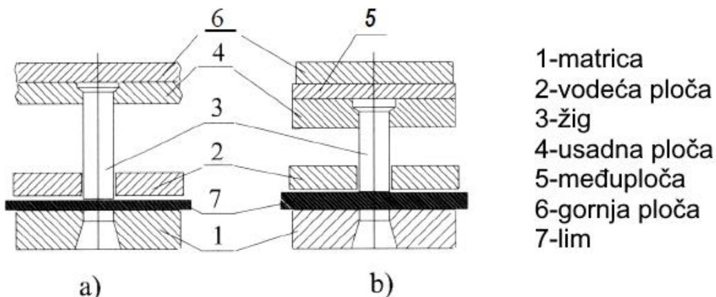
Slika 36 Predodžba sastavljanja štance: a) bez međuploče, b) s međupločom. Izvor [5]
