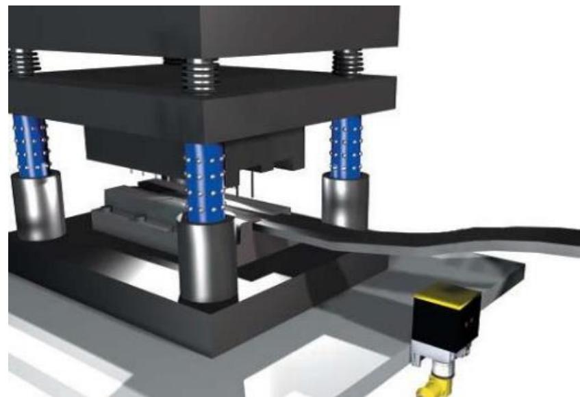
Slika 60 Predodžba senzora za očitavanje prisutnosti trake. Izvor[14]
