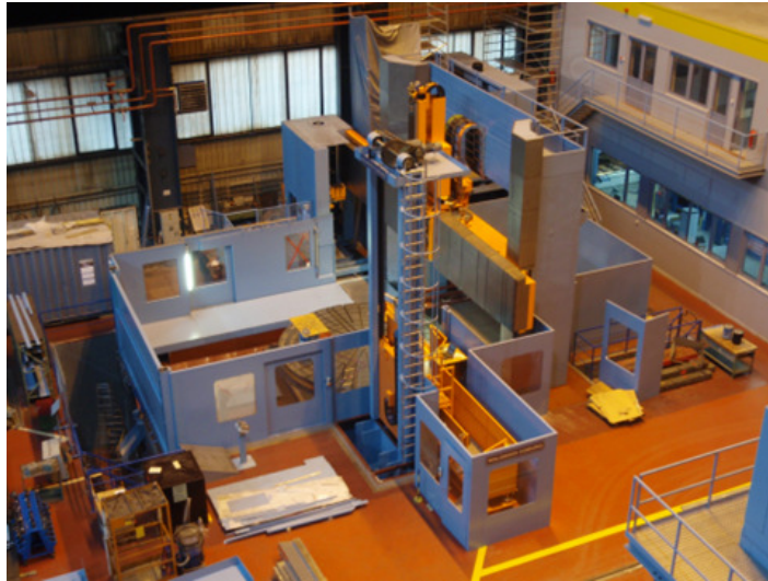
Slika 4.2 Obradni centar Waldrich Coburg MultiTurn 5500 AM
